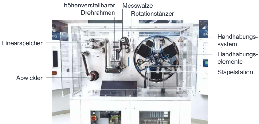
Abbildung 5-26: Realisierung des Anlagenmoduls zur formatflexiblen Stapelbildung (Bedienerseite)
