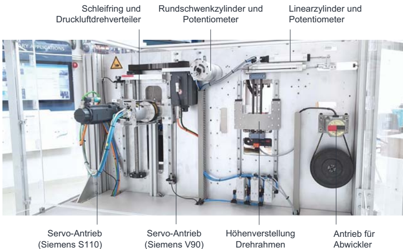
Abbildung 5-27: Realisierung des Anlagenmoduls zur formatflexiblen Stapelbildung (Antriebsseite)
