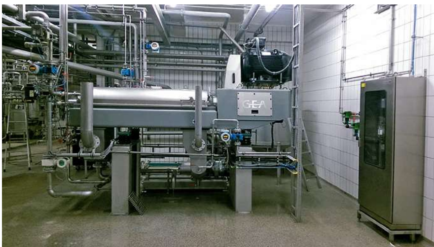
Il sistema Active Torque Control (ATC) automatico per le centrifughe decanter CF evita lo stick-slip (GEA).
