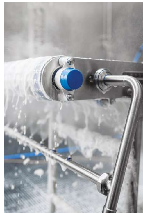
Particolare dell’unità di pulizia CIP per nastri trasportatori (Habasisit).
