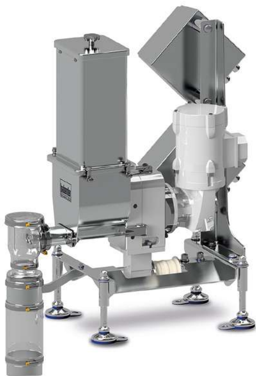
Alimentatore a perdita di peso a doppia vite DDSR20 2.0 con Hygienic Design (Brabender Technologie).
