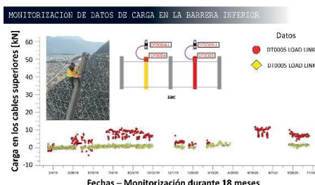
Figura 7. Monitorización de carga en los cables en la barrera inferior del sistema RSN instalado en Vobarno.
