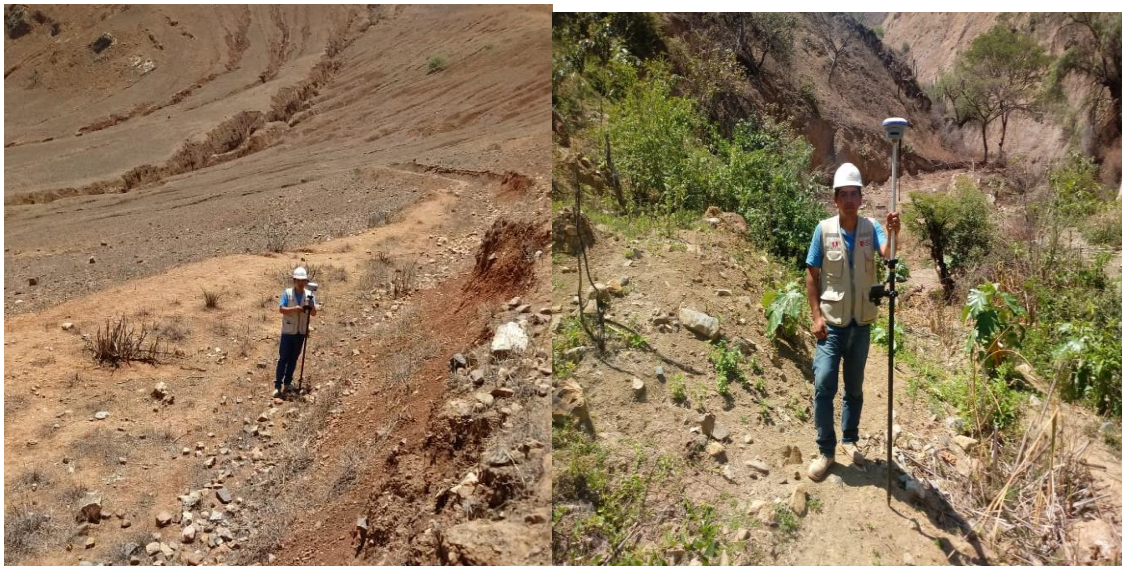
FOTO 04: Tramos del levantamiento topográfico con GPS Diferencial y Prisma.
