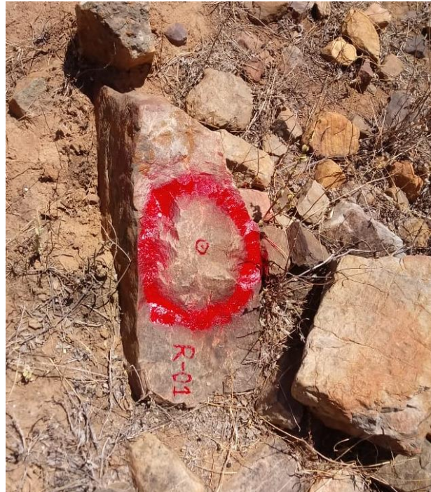
FOTO 02: Colocación del Punto BM para el trazo de la carretera.
