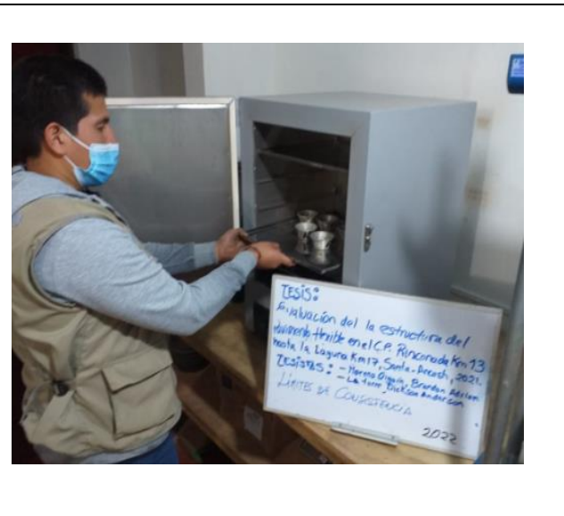
Fotografía: muestras llevadas al horno luego de haber realizado en el instrumento cuchara de Casagrande
