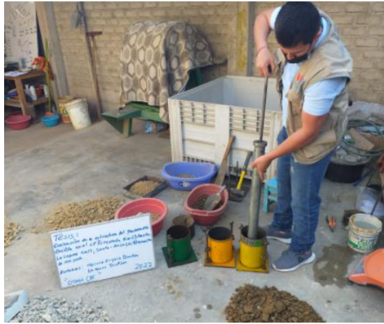
Fotografía: ejecución de compactación de 56, 25 y 12 golpes por 5 capacitación para ensayo de CBR.
