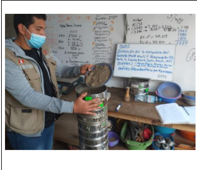
Fotografía: granulometría por tamizado para determinar el tamaño de los materiales que componen a las muestras extraídas
