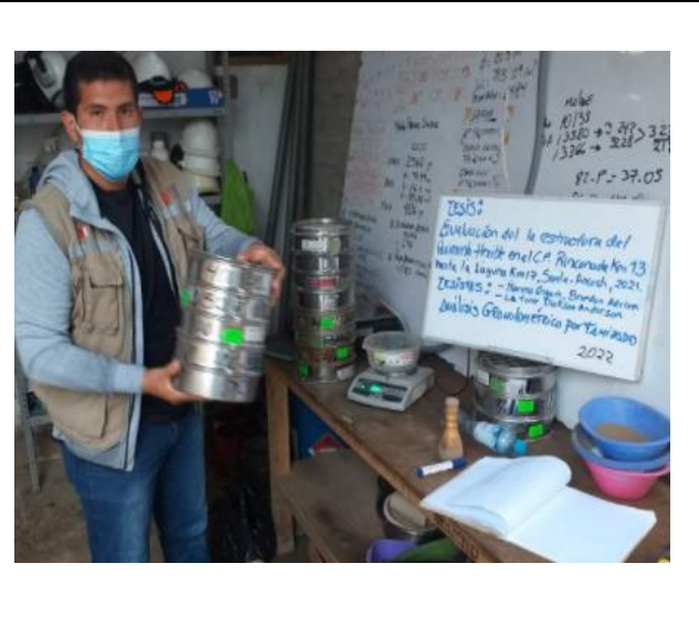
Fotografía: granulometría por tamizado para determinar el tamaño de los materiales que componen a las muestras extraídas
