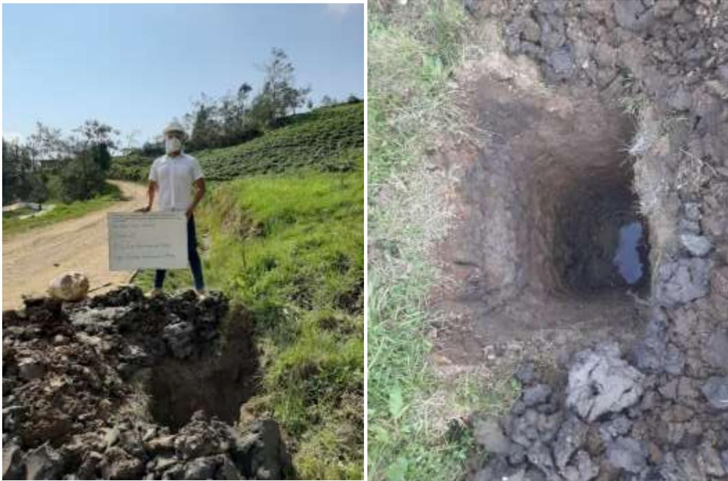
Figura 15: Excavación de calicata - C1
