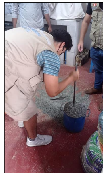
Foto N°6: Se procede a realizar el ensayo para el confitillo de peso unitario compactado.
