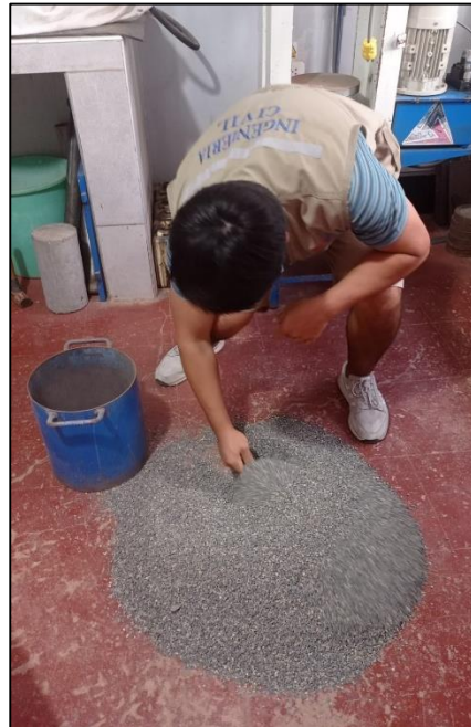
Foto N°4: Se procede a realizar el ensayo para el confitillo de peso unitario suelto y compactado.
