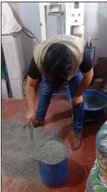
Foto N°6: Se procede a realizar el ensayo para el confitillo de peso unitario compactado.
