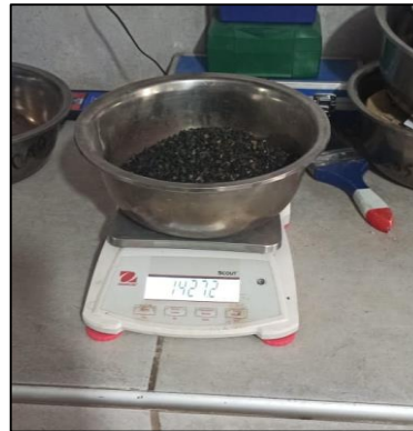
Foto N°13: Muestra del confitillo saturado superficialmente seco en el aire.
