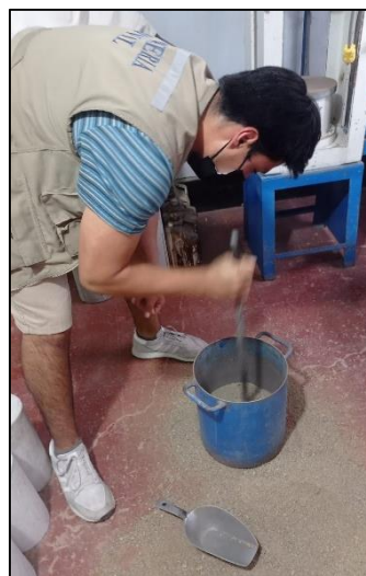
Se compacta por 3 capas y se chusea 25 veces
