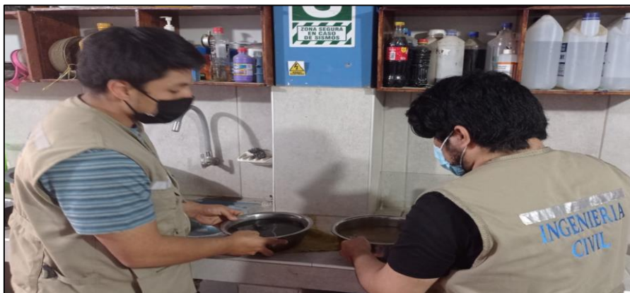
Foto N°12: Se procede a realizar el ensayo de peso específico y absorción de los agregados.
