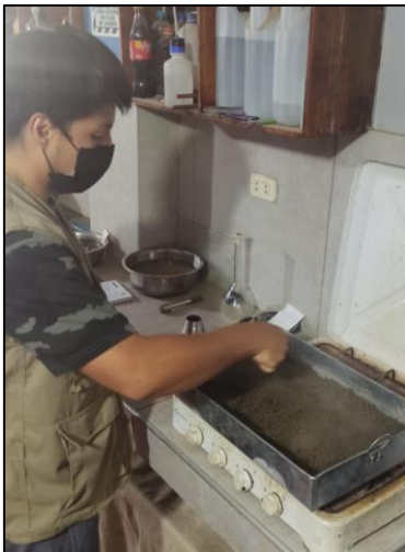
Foto N°18: Para la arena gruesa. Peso de la muestra seca 1.
