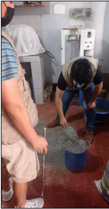
Foto N°5: Se procede a realizar el ensayo para el confitillo de peso unitario suelto
