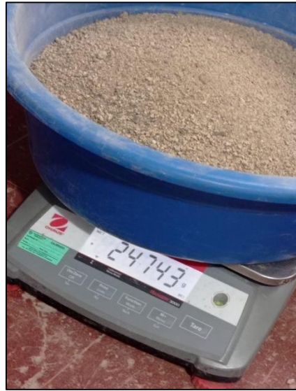
Se pesa la muestra compactada
