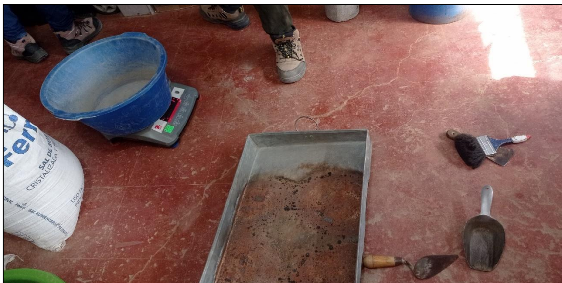
Foto N° 20: Acondicionamiento de materiales y herramientas para dosificación de concreto para unidades de albañilería
