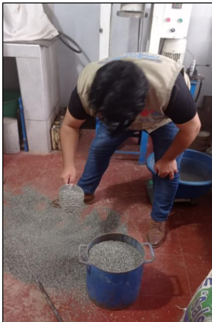
Foto N°4: Se procede a realizar el ensayo para el confitillo de peso unitario suelto y compactado.
