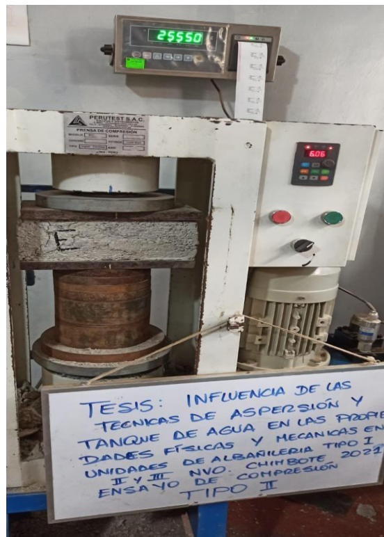
Foto N° 37: Ensayo de resistencia a la compresión en las unidades de albañilería tipo III
