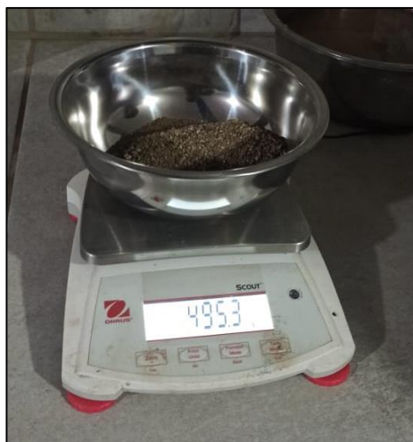
Foto N°19: Para la arena gruesa. Peso de la muestra seca al aire 2.
