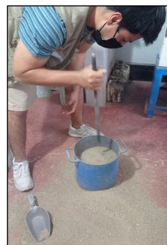
Se compacta por 3 capas y se chusea 25 veces
