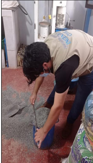
Foto N°5: Se procede a realizar el ensayo para el confitillo de peso unitario suelto
