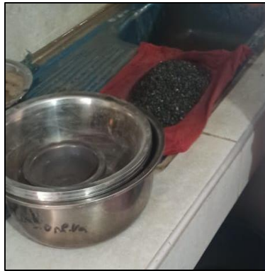
Foto N°13: Muestra del confitillo saturado superficialmente seco en el aire.
