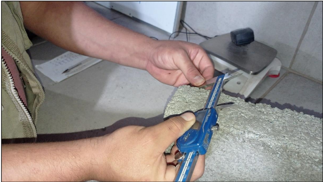
Foto N° 34: Ensayo de variación dimensional por el alto de la unidad de albañilería
