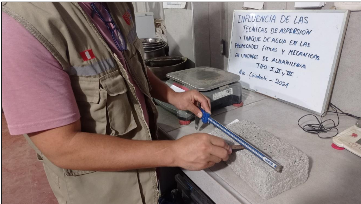
Foto N° 30: Ensayo de Alabeo utilizando vernier y una cuña
