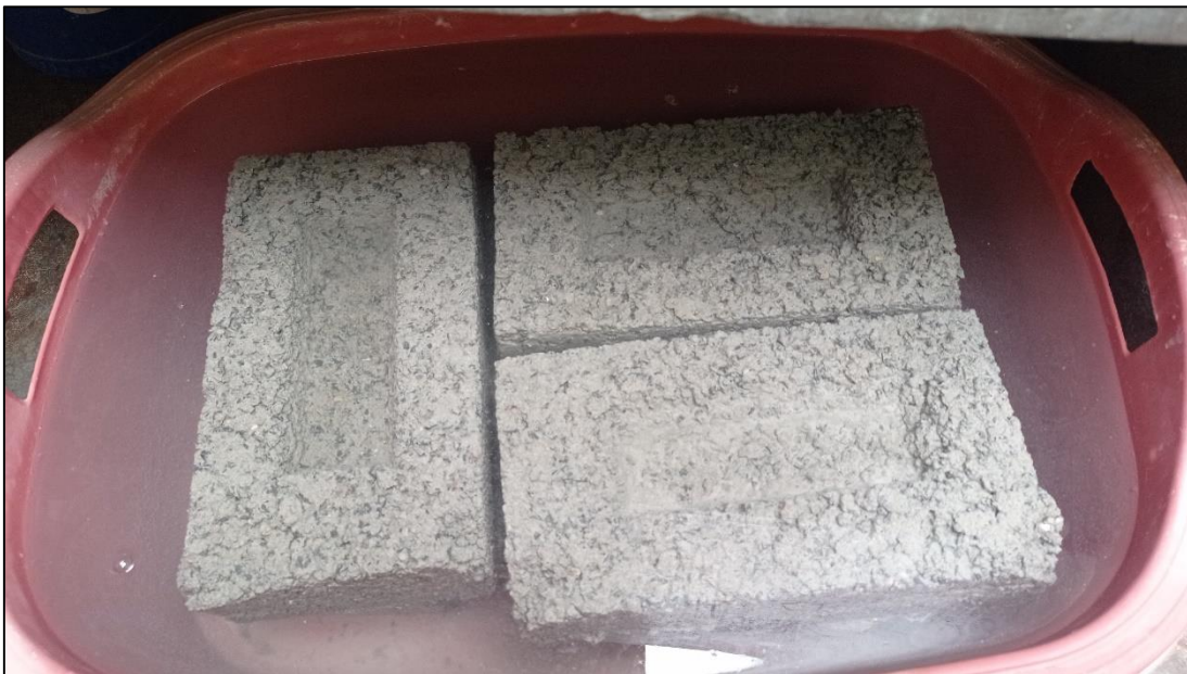
Foto N° 27: Curado de unidades de albañilería por inmersión
