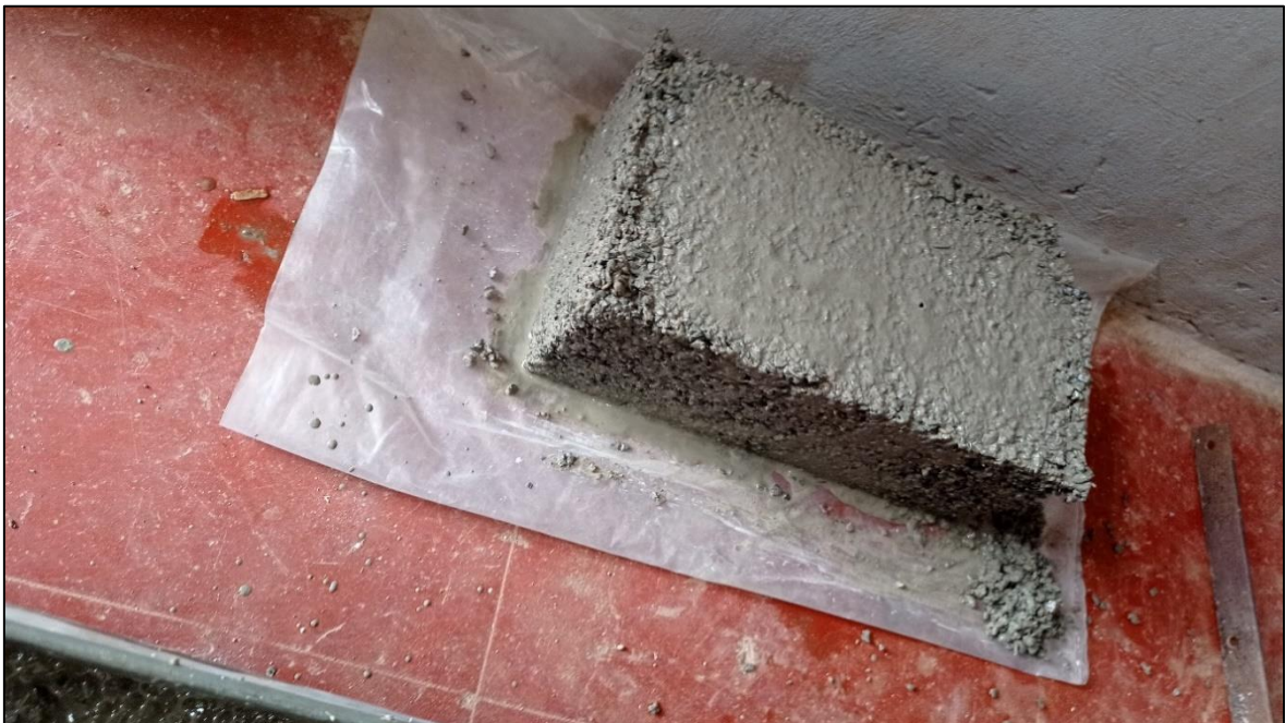
Foto N° 25: Moldeado de ladrillo
