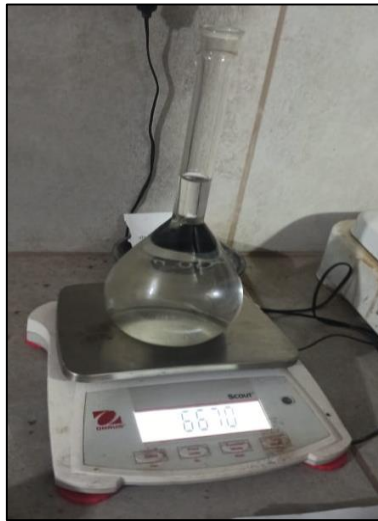
Foto N°17: Para la arena gruesa. Peso de fiola con la muestra y agua.
