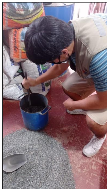
Foto N°6: Se procede a realizar el ensayo para el confitillo de peso unitario compactado.
