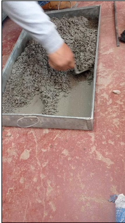
Foto N° 24: Mezcla de agregados gruesos, finos y el agua para la elaboración de unidades de albañilería
