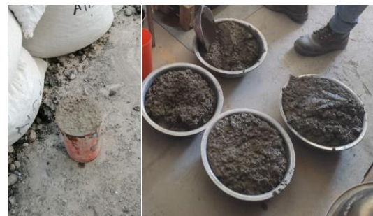
Fotografía N°12: Vaciado de los testigos cilíndricos del concreto patrón.
