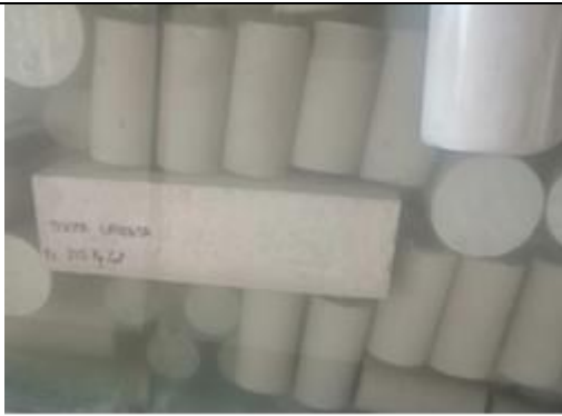
Fotografía N°21: Curado de los testigos cilíndricos y vigas de concreto
