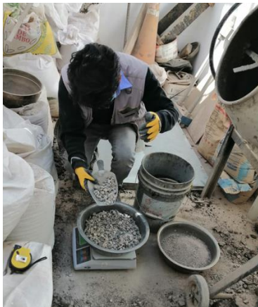
Fotografía N°09: Pesado de materiales para el concreto patrón.
