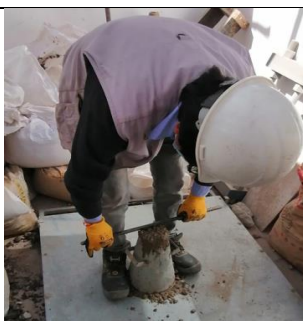
Fotografía N°17: Ensayo de slump del concreto 1% fasteners más (4%, 8% y 12%) con celulosa de papel.
