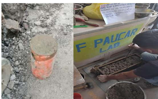
Figura 16. Vaciado de los testigos cilíndricos y vigas de concreto
