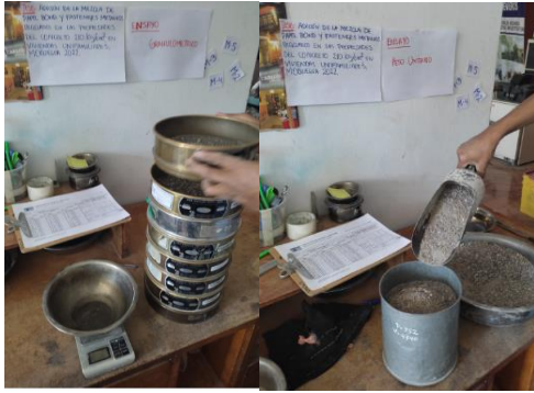
Fotografía N°07: Realización de ensayos para determinar las propiedades físicas de los agregados.
