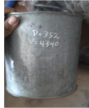
Fotografía N°14: Densidad del concreto fresco del concreto.
