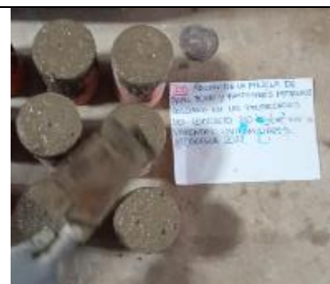
Fotografía N°18: Vaciado de los testigos cilíndricos del concreto 1% fasteners más (4%, 8% y 12%) con celulosa de papel.
