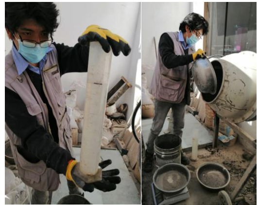
Fotografía N°10: Preparación junto a la mezcladora para el concreto patrón.
