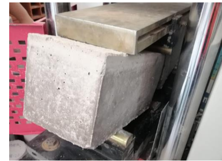
Fotografía N°24: Resistencia a la flexión del concreto
