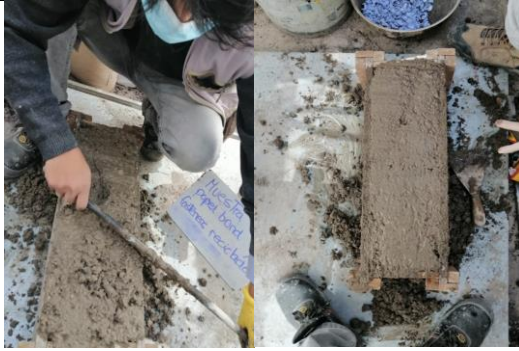
Fotografía N°19: Vaciado de las vigas del concreto 1% fasteners más (4%, 8% y 12%) con celulosa de papel
