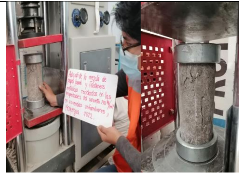
Fotografía N°22: Resistencia a la compresión del concreto
