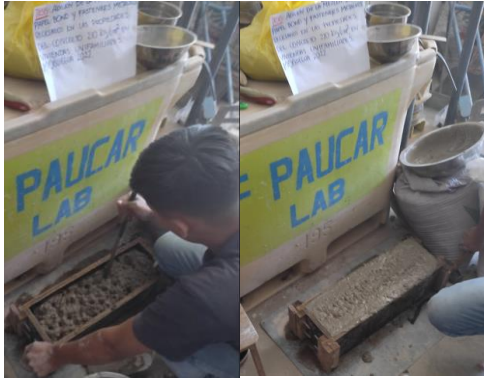
Fotografía N°13: Vaciado de las vigas del concreto patrón.
