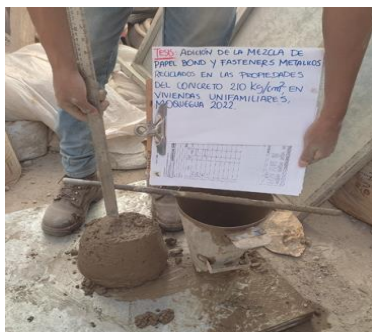
Fotografía N°11: Ensayo de slump del concreto
