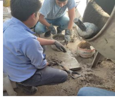
Fotografía N°20: Densidad del concreto fresco del concreto 1% fasteners más (4%, 8% y 12%) con celulosa de papel
