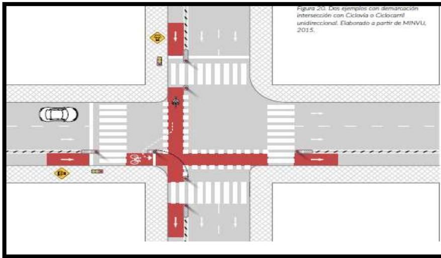
Ilustración 5 Intersección de Ciclovía con Pista tipo 2(fuente Municipalidad de Lima 2017)
