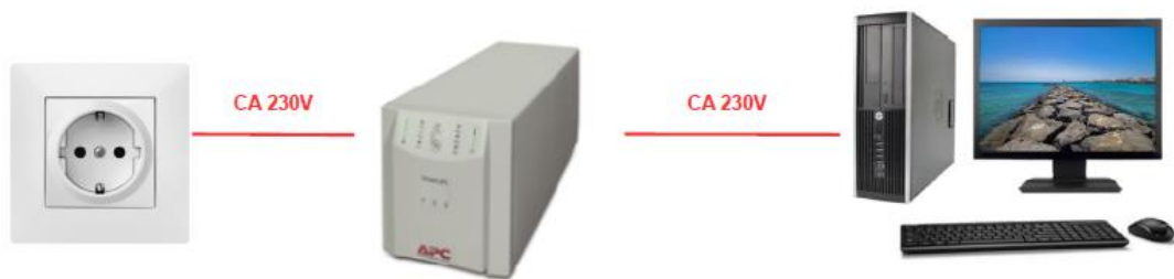
Figura 4.1. Esquema de conexión del SAI con el PC (Fuente: Elaboración propia)
