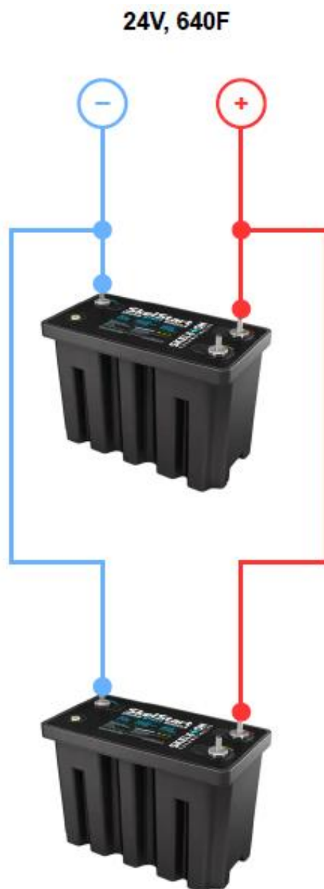
Figura 4.10. Conexión de las baterías de supercondensadores en paralelo en el tercer diseño (Fuente: Elaboración propia)
