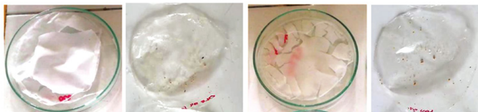
Figura 76. Películas de PLA MC-Funcionalizada en THF y CHCl 3 . De izquierda a derecha: THF MC-Ole 1 %, CHCl 3 MC-Ole 1 %, THF MC-Lau 1 % y CHCl 3 MC-Lau 1 %
