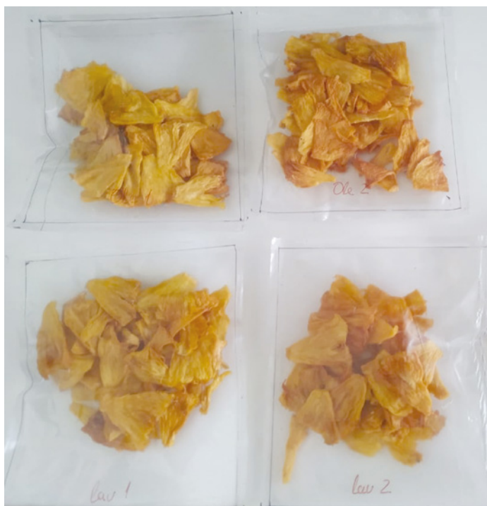
Figura 80. Empaques obtenidos de PLA MC-Ole y MC-Lau al 1 %, con Tween 80 como aditivo para el almacenamiento de snacks de piña
