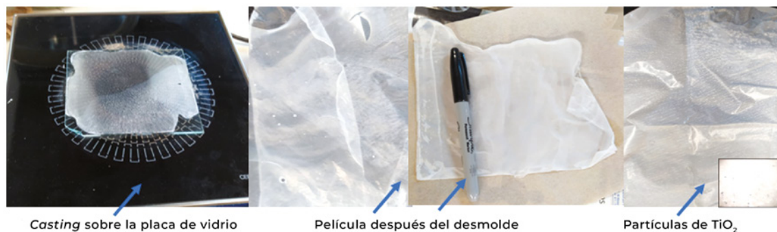
Figura 42. Proceso de casting hasta la obtención de las películas de PLA/TiO 2 -Zn/Bergamota
