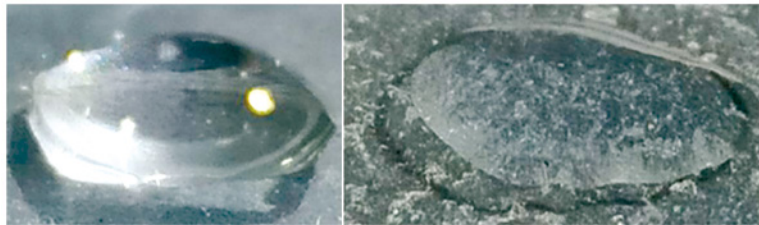
Figura 78. Prueba de hidrofobicidad de manera artesanal mediante medición de ángulo de contacto de las películas, PLA MC-Ole 1 % y Tween (izquierda) y PLA MC-Lau 1 % y Tween (derecha) con agua
