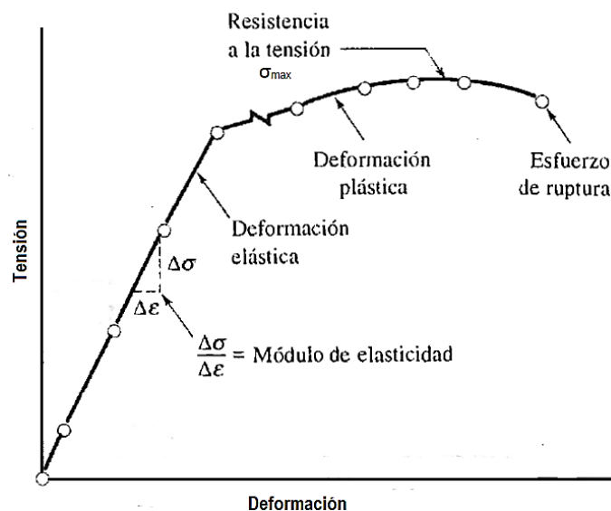
Figura II.2. Esquema de la curva de tensión – deformación para un material polimérico [19].
