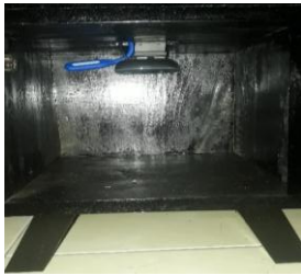
Gambar 5. Kotak Bagian Bawah Alat Identifikasi Jenis Kayu
