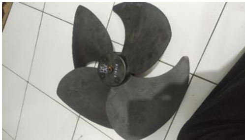
Gambar 7. Baling-baling prototipe PLTB
