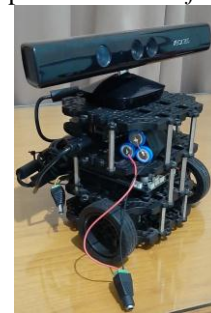
Gambar 5 Depth sensor camera yang telah terpasang pada Turtlebot3 burger
