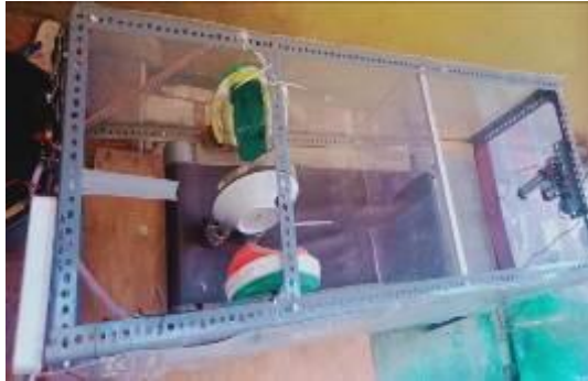
Gambar 12 Bentuk keseluruhan sistem dishwasher dengan pengering
