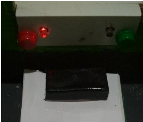
Gambar. 7 Gambar push button dan led warna merah Tampilan website pada kamar 1 akan berwarna kuning yang menandakan pasien dikamar 1 membutuhkan penanganan.
