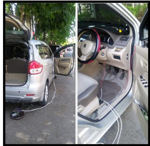
Gambar 9. Alat Rancangan dihubungkan ke Sistem Kelistrikan Mobil dan Sensor alat rancangan diberi paparan gas buang
