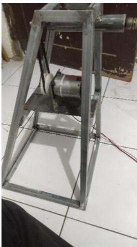
Gambar 8. Kopel antara turbin angin dengan generator.
