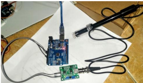
Gambar 3. Pengujian Sensor pH Dengan Arduino
