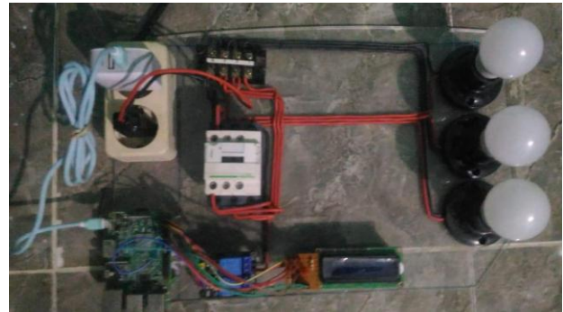
Gambar 5. Rangkaian hardware yang tersusun dalam sistem Informasi Manajemen Gedung Serbaguna berbasis website.
