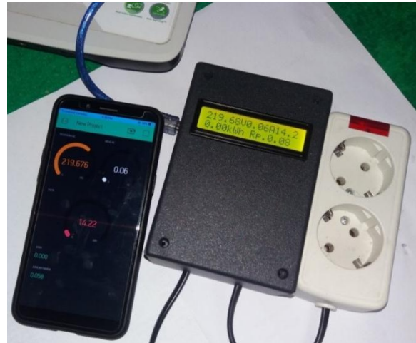
Gambar 6 Alat Pembaca kWh Meter
