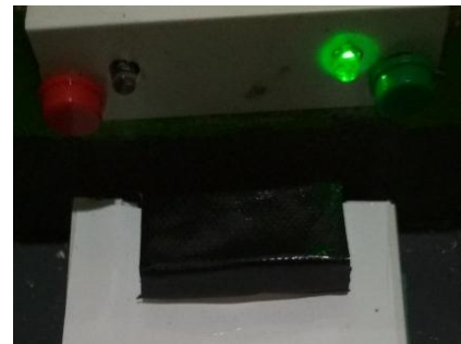
Gambar 10. Gambar push button dan led warna hijau Tampilan website pada kamar 1 berwarna hijau yang menandakan pasien dikamar 1 telah mendapatkan penanganan.
