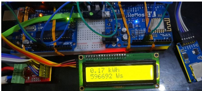
Gambar 8 Display Data Akumulasi pada LCD 16x2
