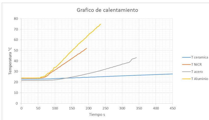
**Figura 6.** Gráfica de comparación de calentamiento de diferentes resistencias
