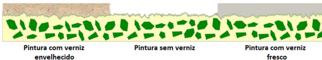
Figura 1.25 Diagrama representativo da pintura (substrato do pigmento mais aglutinante) coberto por uma camada protetora envelhecida à esquerda, transparente fresco à direita e sem camada protetora no centro. (Adaptado de [25])
