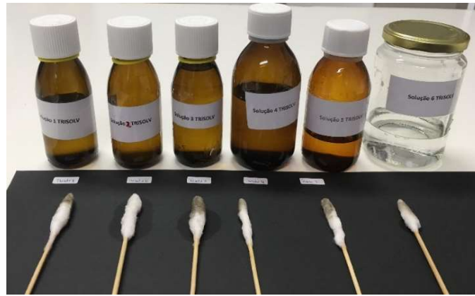
Figura 3.2 Testes de limpeza realizadas numa pintura com 6 TriSolv® ((Adaptado de [37])
