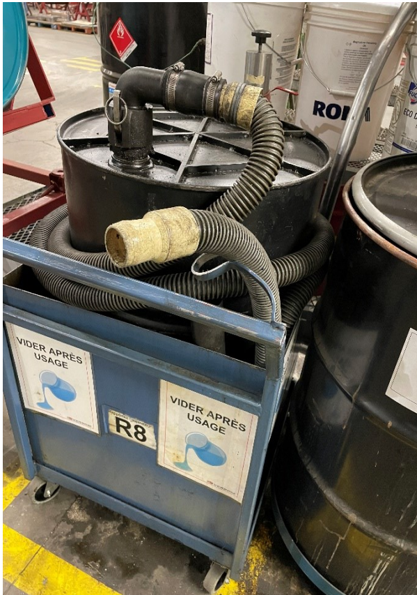
Figure 2.6 : Dispositif d'aspiration du fluide de coupe usé de l'intérieur des CNC (prise à Verbom Inc. Valcourt, aout 2022)
