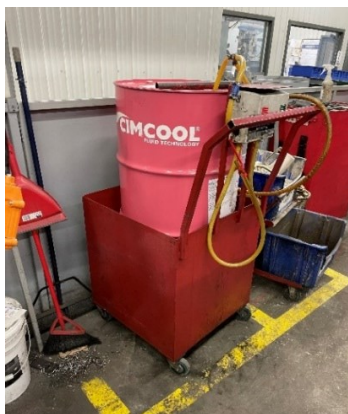
Figure 2.5 : Récipient de préparation du mélange aqueux (prise à Verbom Inc. Valcourt, aout 2022)
