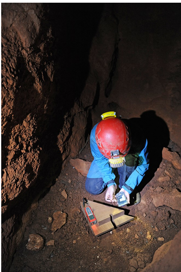
Figura 5-7: Calibração do DistoX com o AESDA Calib, por MJP (24/05/2015), na Gruta da Pedreira, Olhão.
