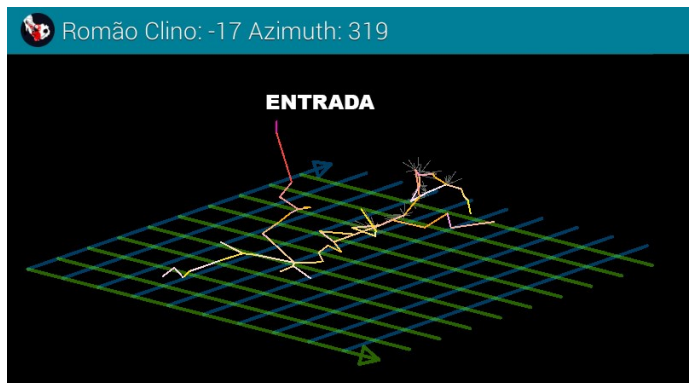
Vista 3D da poligonal topográfica com a aplicação Cave3D.
