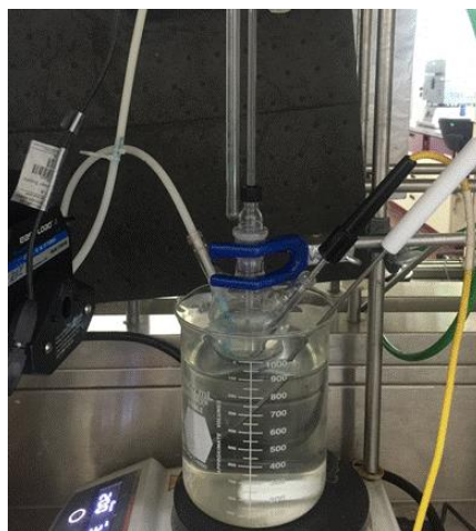
Figura 10. Sistema empleado para la absorción y foto-reducción de CO 2
