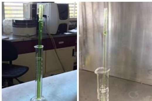
Figura 9. Preparación de las películas en el capilar de cuarzo.
