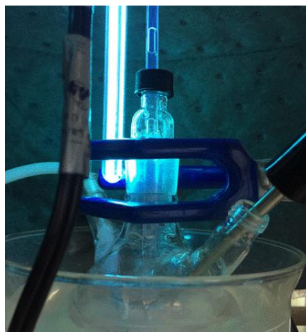
Figura 11. Reducción fotocatalítica de CO 2 en el reactor capilar
