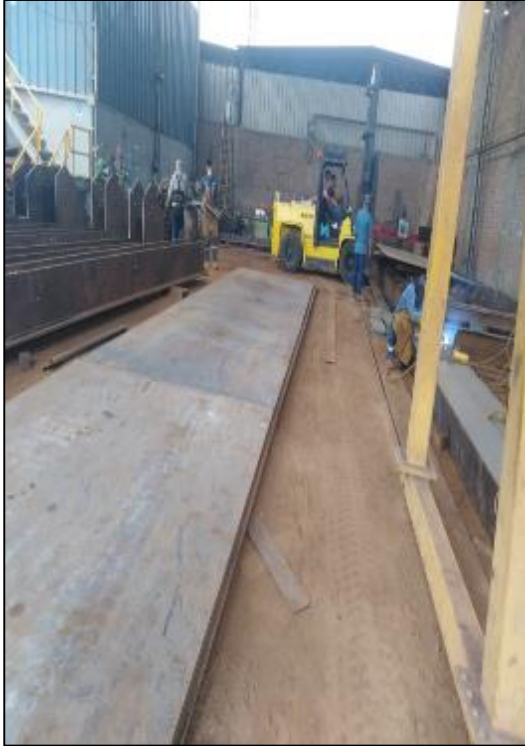
26 DE NOVIEMBRE DEL 2020: Se inician los trabajos de fabricación de estructuras metálicas según diseño y verificación de los trabajos de corte con plasma de las planchas de acero.
