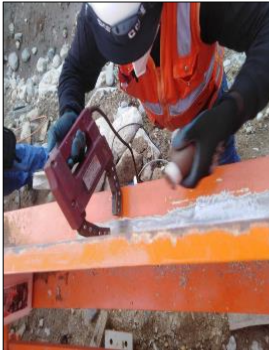
05 DE ABRIL DEL 2021: Se observa los trabajos de control de calidad de la soldadura, con el ensayo de partículas magnéticas.
