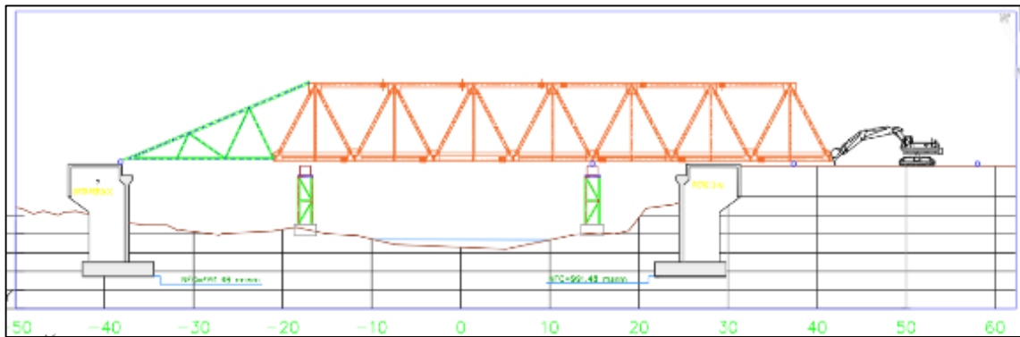
FIGURA 21: Empuje desde la parte de atrás con maquinarias y equipos.
