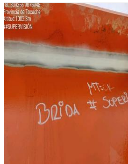
05 DE ABRIL DEL 2021: Se observa los trabajos de control de calidad de la soldadura, con el ensayo de partículas magnéticas.
