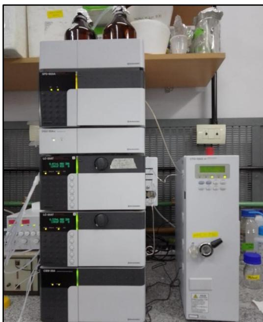
Figura 2.8. Equipo de HPLC utilizado para la determinación de vitamina C
