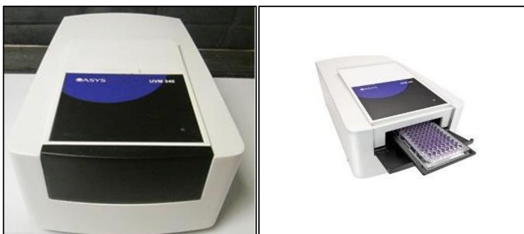
**Figura 2.9. Equipo utilizado para la determinación de compuestos fenólicos totales**
