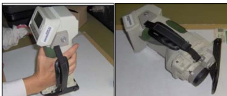
Figura 2.7. Equipo utilizado para las determinaciones de color de los diferentes batidos vegetales
