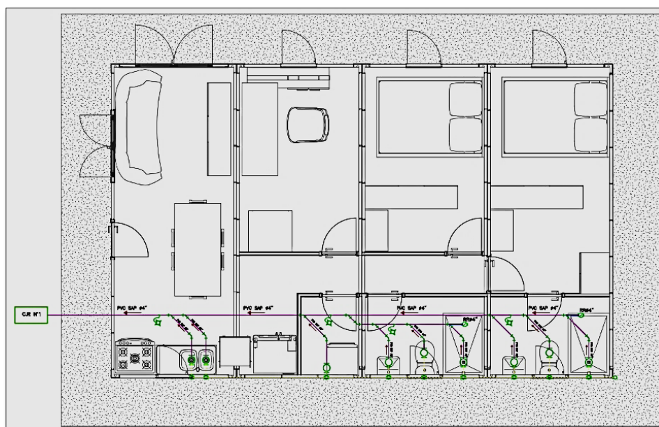
Figura 62 Red de desagüe y ventilación para el proyecto de vivienda social modular
