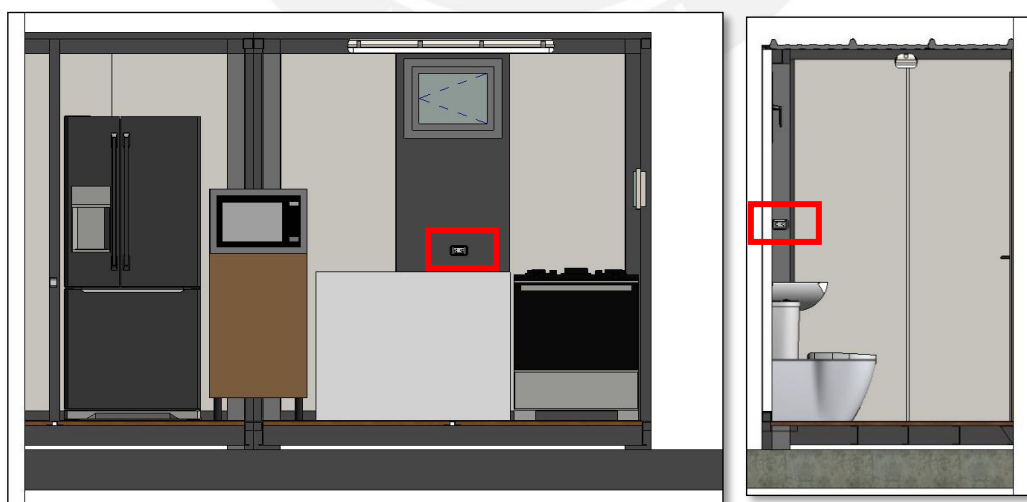
Figura 65 Tomacorriente alto en cocina y baño 01 Tomado de elaboración propia – Lima (2021). Modelado Revit vista en corte
