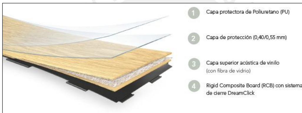
Figura 17 Composición de piso vinílico con sistema clic
