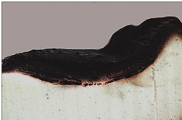
Figura 72 Poliuretano carbonizado después del contacto con fuego
