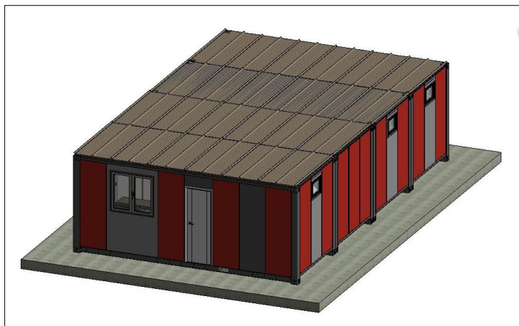
Figura 53 Techo con panel tipo sándwich modelo AIS 3G Tomado de elaboración propia – Lima (2021). Modelado Revit vista 3D
