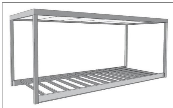
Figura 26 Estructura metálica del módulo Flat-Pack Tomado de Alquimodul – Perú (2017). Sistema de construcción modular Flat-Pack (Fuente: Alquimodul, 2017b).
