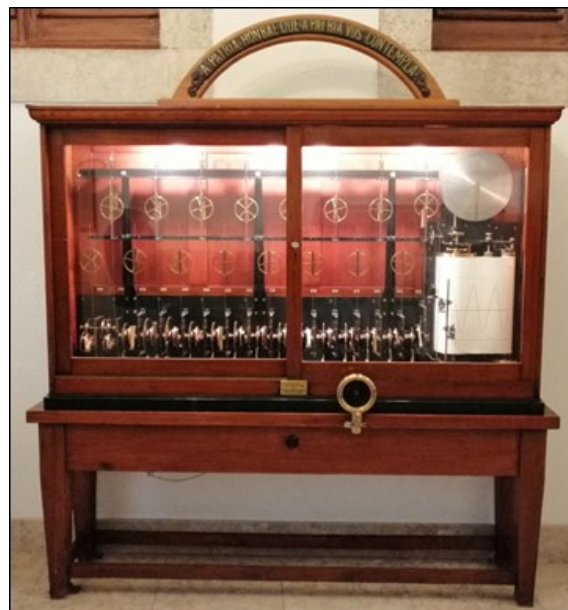
FIGURA 1.7: Previsor de marés desenvolvido por Lord Kelvin que se encontra no IH
