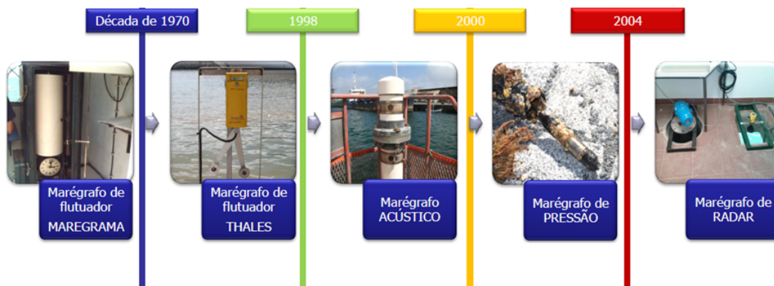
FIGURA 2.2: Evolução tecnológica dos equipamentos maregráficos (Fonte: Imagens cedidas pela Divisão de Oceanografia do IH)
