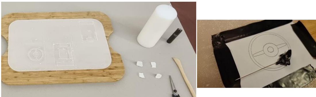
Figura 28: Placa em cera com carimbo moldado para gravar caracteres em braille.
