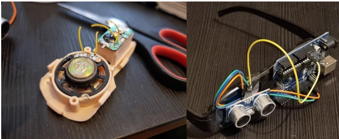
Figura 34: Coluna de som à esquerda e óculos de ecolocalização à direita.
