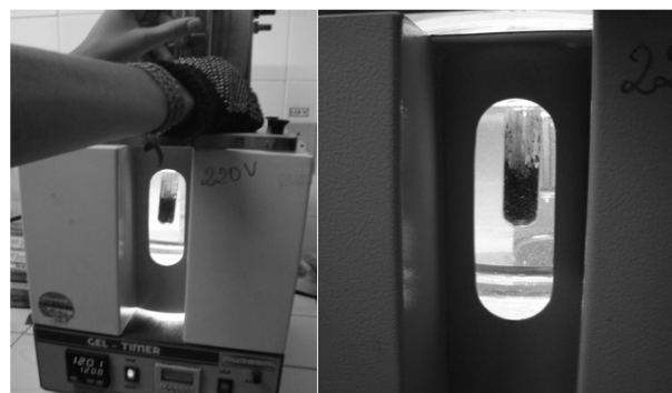
FIGURA 1: Gel-timer com amostras de adesivo de taninos vegetais.
