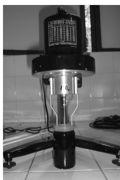
FIGURA 2: Viscosímetro Brookfield- LV com amostra.
