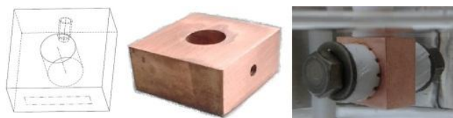
Figura 1. Probeta PCA, sin y con formador de rendijas.
