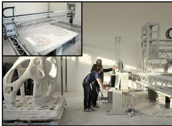
Figura 13. Impressió amb la tecnologia D-Shape amb la mostra d'una peça realitzada amb aquesta tècnica [21]
