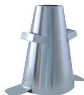
Figura 44. A l'esquerra esquema i mides del motlle cònic del con d'Abrams. A la dreta imatge del motlle cònic. [52]
