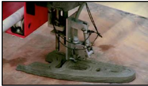
Figura 12. Impressió de peça en forma de la lletra A amb la tecnologia Concrete Printing [20]
