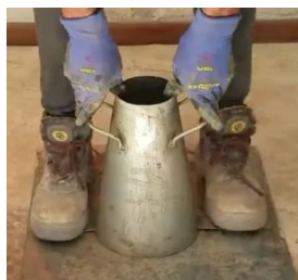
Figura 48. Col·locació del motlle cònic sobre la plataforma metàl·lica [54]
