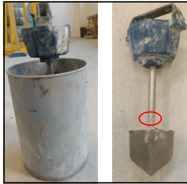
Figura 54. A l'esquerra, mesurador de plasticitat introduït en un cubell amb morter. A la dreta, vista lateral del mesurador de plasticitat on s'indica la marca fins on s'ha d'introduir l'aparell al formigó.
