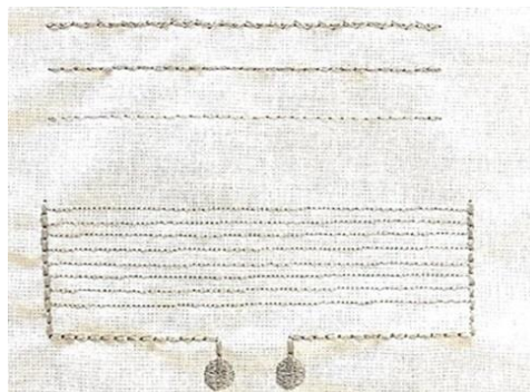
Figura 21. Bordado con hilo conductor
