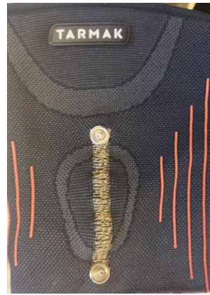
Figura 51. Sensor textil de un estudio previo [31]
