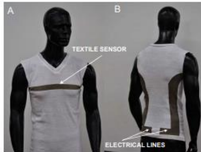
Figura 10. Prototipo de una camiseta tetrónica para medir la frecuencia respiratoria. [2]
