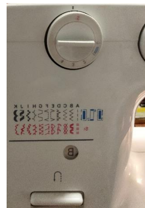
Figura 40. Tipo de bordados máquina de coser
