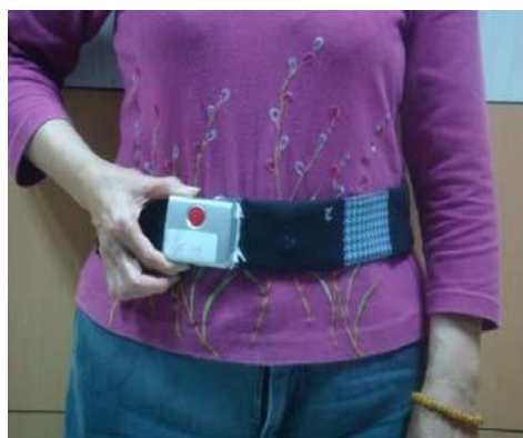
Figura 11. Sensor digital en forma de cinturón abrochado entre el pecho y la cintura. [3]
