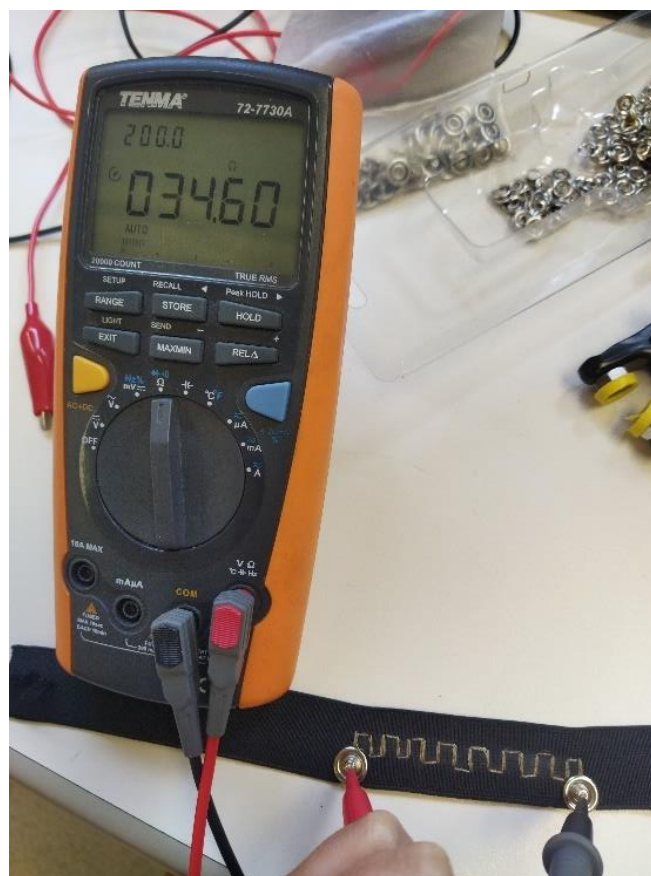
Figura 48. Cálculo de la resistencia con el Multímetro
