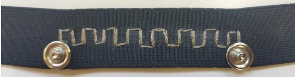
Figura 47. Tercer sensor con snap buttons
