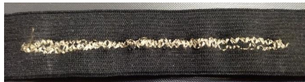
Figura 43. Sensor 2 tejido con máquina
