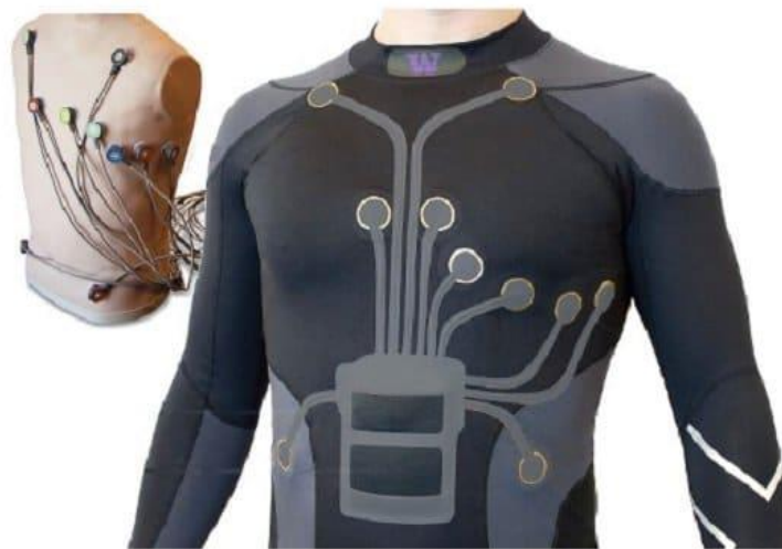
Figura 15. Sensor Wearable integrado en la ropa
