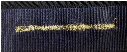
Figura 42. Sensor 1 tejido con máquina
