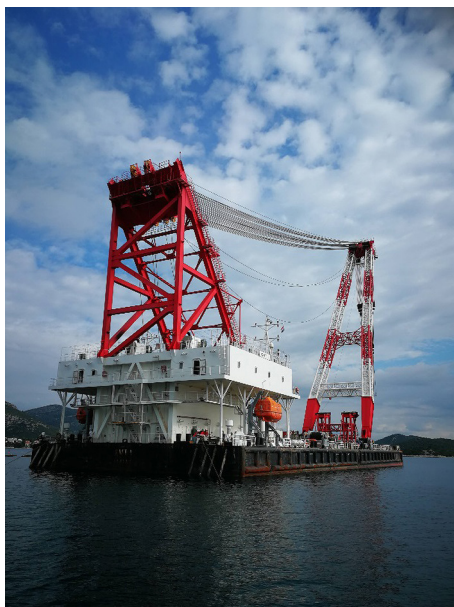
Slika 3. Dizalica nosivosti 1000 tona.
