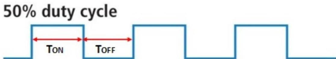
Fig. 3.25. PWM DE LLEGADA AL TRANSISTOR PRINCIPAL
