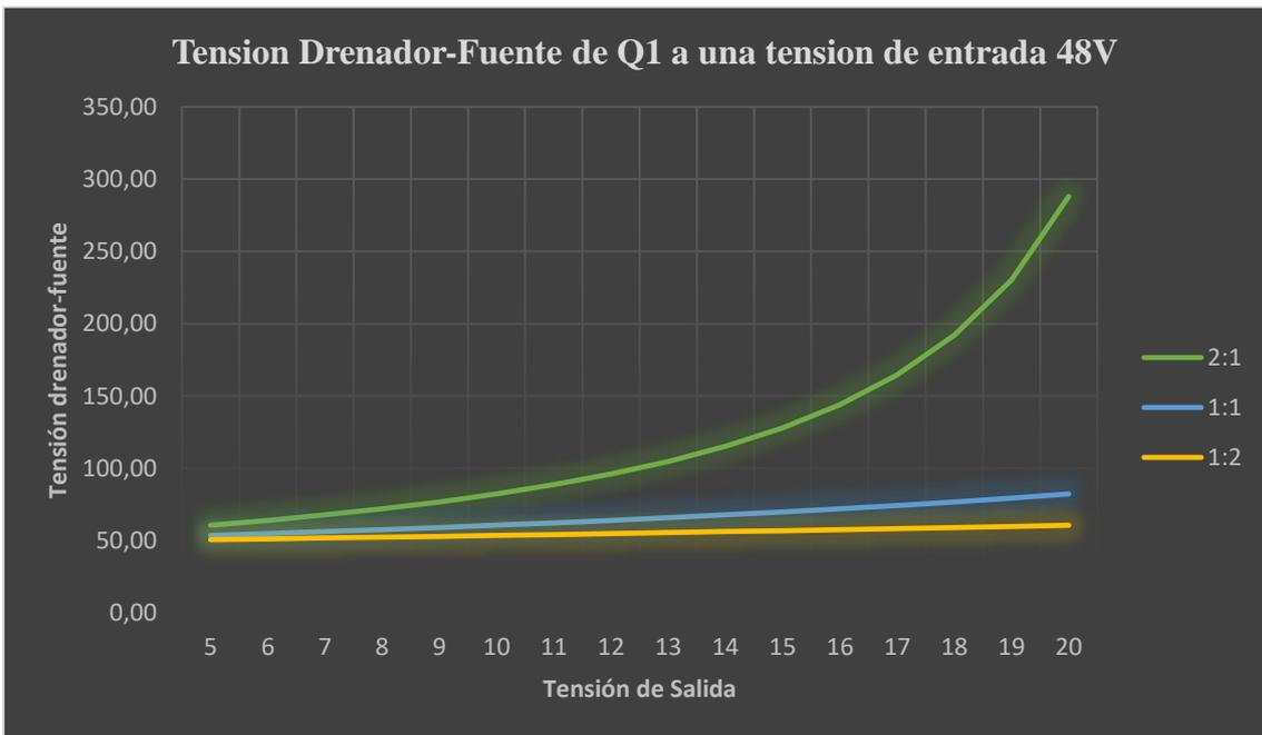
Fig. 2.13. GRÁFICA TENSION DE DRENADOR-FUENTE DEL TANSISTOR PRINCIPAL CON ENCLAVAMIENTO ACTIVO HIGH-SIDE
