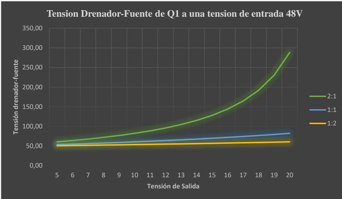
Fig. 2.17. GRÁFICA TENSION DE DRENADOR-FUENTE DEL TANSISTOR PRINCIPAL CON ENCLAVAMIENTO ACTIVO LOW-SIDE
