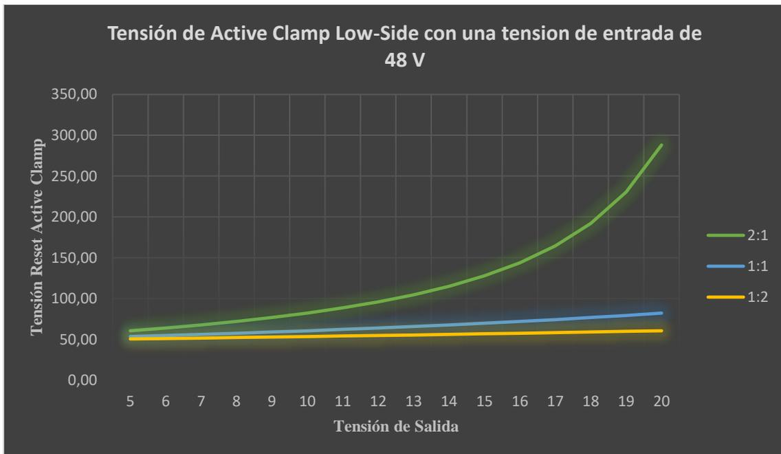
Fig. 2.16. GRÁFICA TENSION DEL ENCLAVAMIENTO ACTIVO LOW-SID
