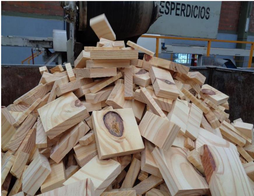
*Figura 6.1. Despunte y eliminación de defectos de tablas aserradas (Corrientes).
