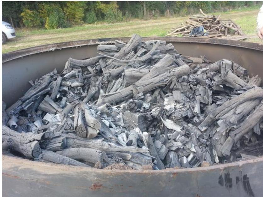
*Figura 6.32. Carbonización finalizada en horno TPI-CTM.
