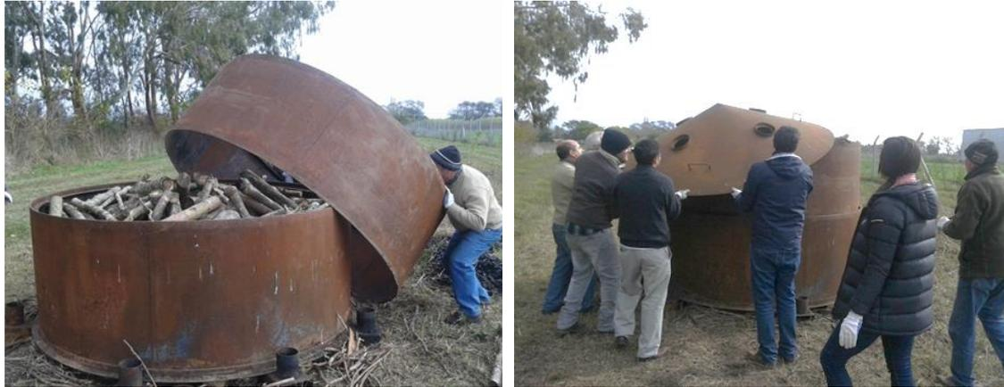
*Figura 6.31. Montaje, carga y cierre del horno TPI-CTM.
