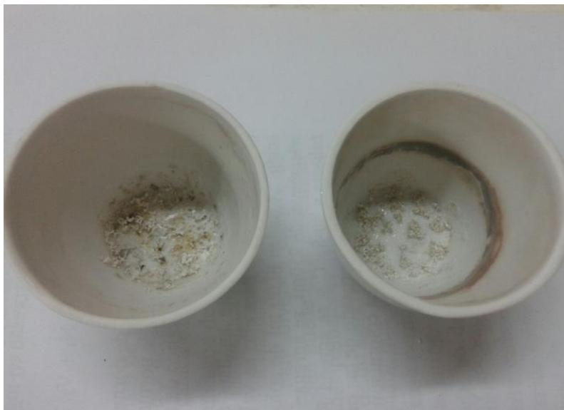
Figura 6.12. Determinación de contenido de cenizas en madera-LIMAD.
