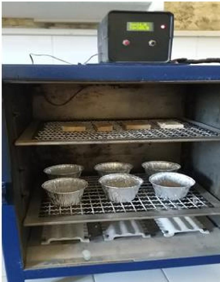
Figura 6.11. Determinación de contenido de humedad de aserrín y despuntes en estufa-LIMAD.
