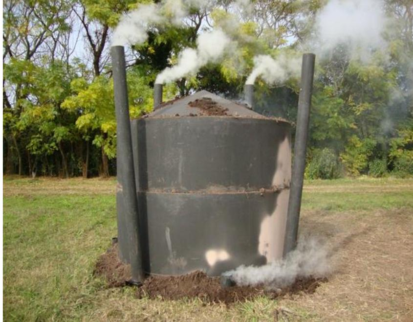
*Figura 6.30. Horno TPI en funcionamiento-CTM.
