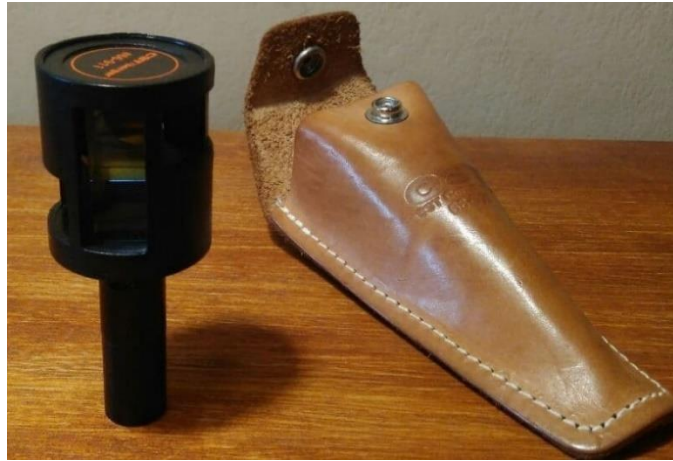
Figura 3.12: b: Pentaprisma Doble
