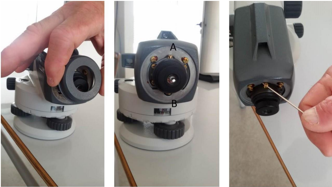
Figura 3.37: Corrección de error de colimación en niveles automáticos
