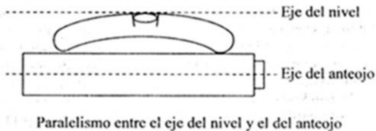
Figura 3.27: Ejes de colimación y del nivel tubular
