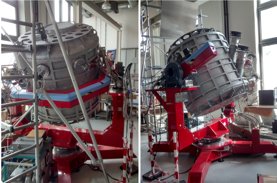
Figura 2.2: Fotos del instrumento QUBIC-TD en el APC, París, Francia. En la foto de la izquierda se observa la ventana de observación (círculo blanco). En la imagen de la derecha se observa el espejo (arriba a la izquierda) utilizado para reflejar la radiación de la fuente puntual para situarla en el campo lejano. Se observan también los tubos pulsantes. Todo el crióstato está sobre la montura (roja) utilizada para el escaneo.
