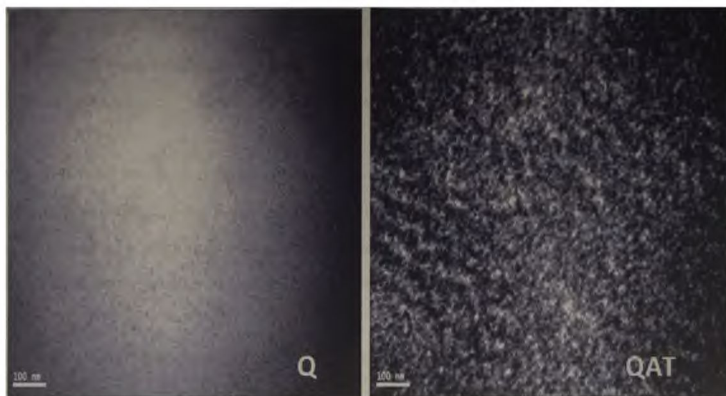
Figura 4.6 Micrografías obtenidas por TEM de películas de quitosano (Q) y de películas entrecruzadas con ácido tánico (QAT).
