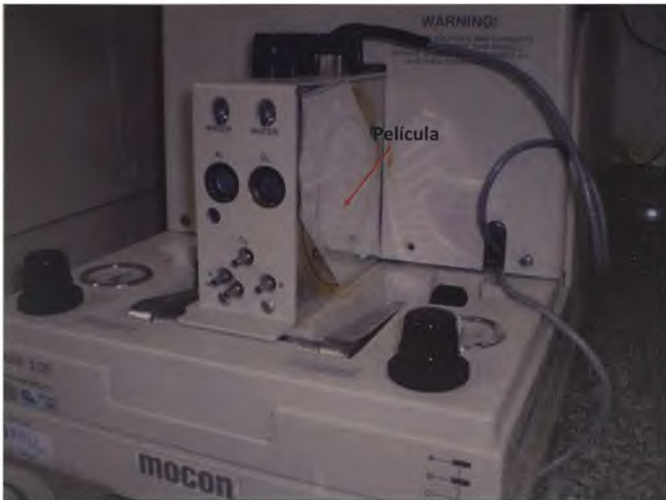
Figura 4.2 Fotografía del equipo utilizado para determinar la permeabilidad al oxígeno de las películas.
