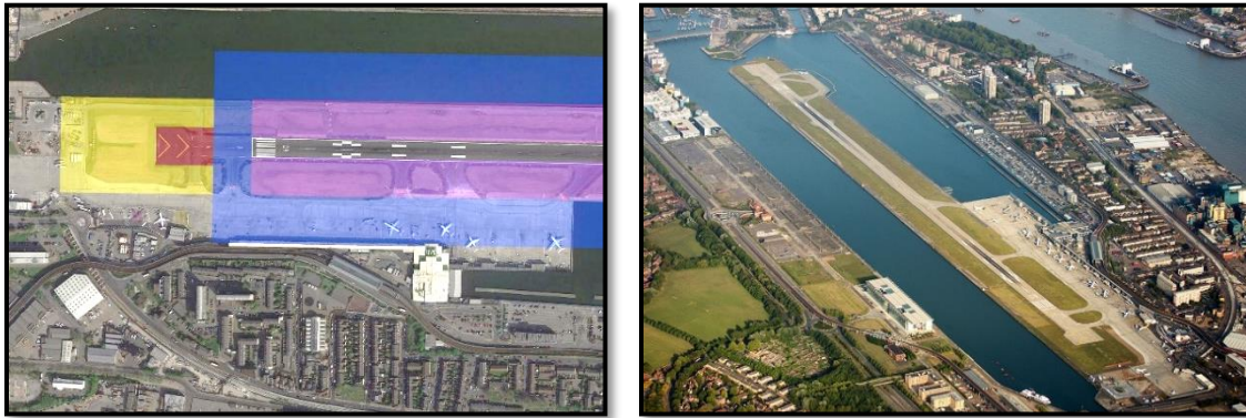
Figura 25: Aeropuerto EGLC con plataforma dentro de la franja de pista. Fuente: Google Earth.
