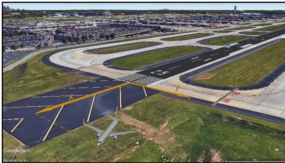
Figura 44: Sistema de coordenadas para modelo de Overrun. Fuente: Elaboración propia.
