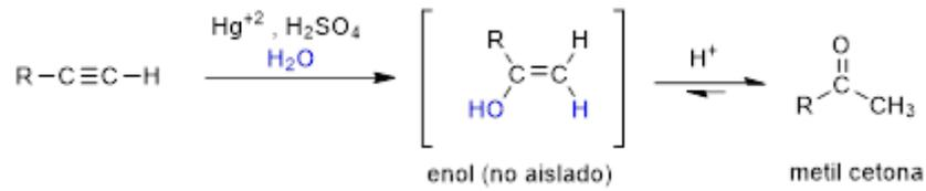
Mecanismo: la adición electrofílica del ion mercúrico genera un catión vinilo, el cual reacciona con agua y pierde un protón para formar un alcohol organomercurial. Bajo condiciones de reacción ácidas, el mercurio es remplazado por el hidrógeno para formar un alcohol vínicico, llamado enol.
