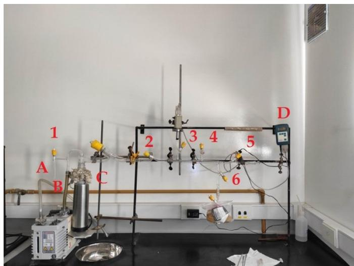
*Figura 2.1* Fotografía de una línea de vacío del CEQUINOR. 1- 6: llaves PTFE; A: salida al exterior; B: salida a la bomba mecánica; C: trampa con nitrógeno líquido; D: manómetro.
