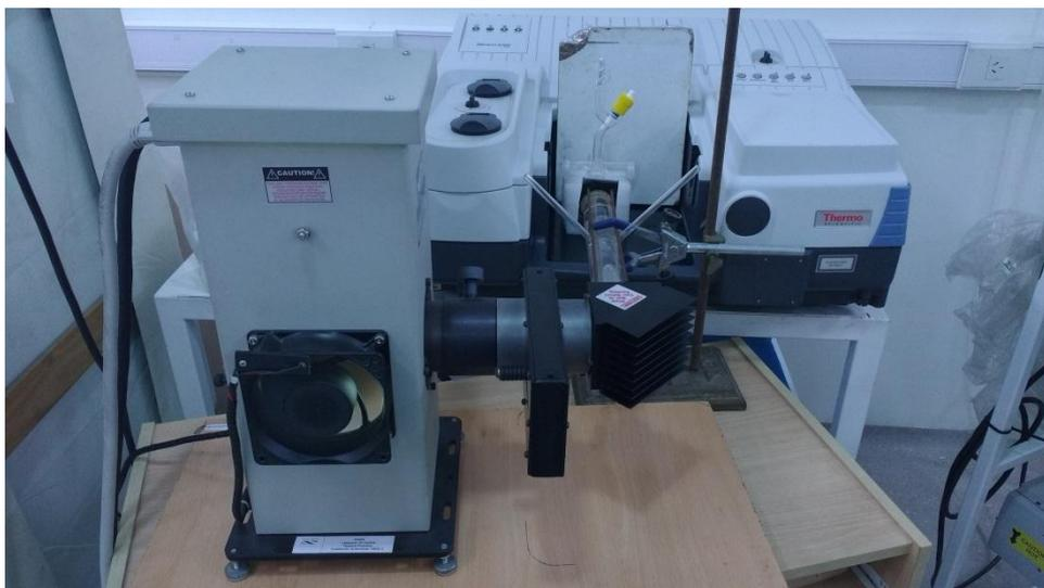
**Figura 2.5** Lámpara de arco Hg-Xe (Spectra Physics, modelo 69920) con el espejo dicróico de 280-320 nm empleada para una experiencia de fotoquímica en fase gaseosa.
