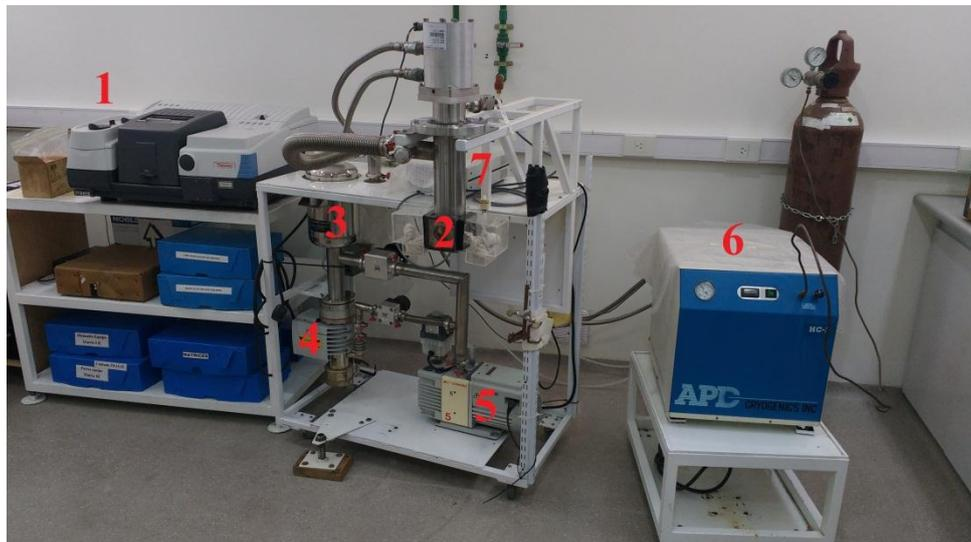
**Figura 2.6** Equipo de matrices de gases inertes de 10 K y espectrofotómetro Thermo-Nicolet modelo 6700 (1). En la imagen se indican las diferentes partes que conforman la matriz. 2: cabezal de la matriz, 3: trampa de nitrógeno líquido, 4: bomba difusora marca Edwards, 5: bomba de vacío mecánica marca BOC Edwards, 6: compresor de helio HC-2D-1 y 7: controlador de temperatura marca LakeShore Cryotonics.
