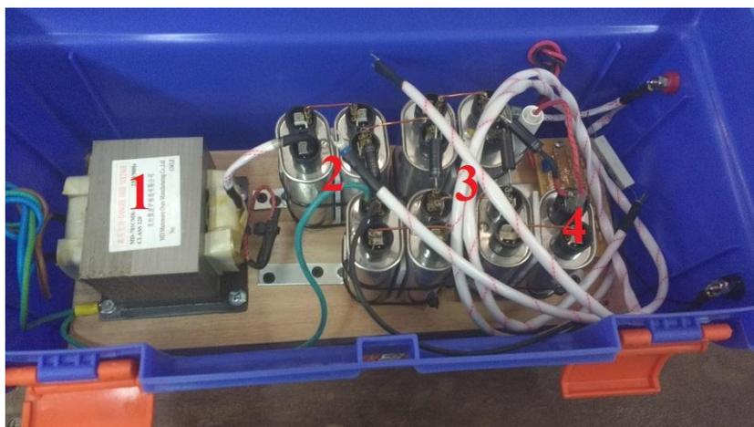
**Figura 2.7** Fuente de alta tensión diseñada y fabricada en CEQUINOR. **1:** Transformador de alta tensión (220 a 2200 V), **2:** Primer etapa duplicadora (2200 a 4400 V), **3:** Segunda etapa duplicadora (4400 a 10000 V), **4:** Conversor de corriente alterna a corriente continua.
