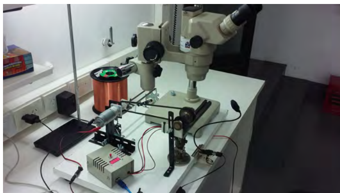
Figura III.4: Bobinador construido a partir de un torno de relojería para el armado de bobinas de distintos tamaños. Además se armó un cuenta vueltas con arduino. Todo esto nos permitió trabajar con la precisión necesaria para el enrollado de bobinas tan pequeñas.
