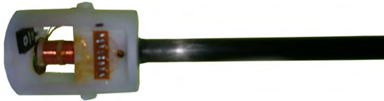
Figura II.1: Sonda hecha a medida para los experimentos de susceptibilidad ac. En la imagen puede verse el extremo de la sonda donde se halla el susceptómetro propiamente dicho, junto con una punta Hall para medir el campo magnético. El primario, que genera el campo oscilante, consta de dos bobinas de Helmholtz superconductoras, externas a la sonda. Las mismas permiten poner un campo alterno máximo de 0.025 T a 100 Hz. El campo externo estático es generado por un imán superconductor de 9 T.
