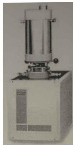
**Figura 2.9.** Analizador térmico NETZSCH 409/c
