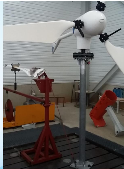
Figura 9: Ensayos de Esfuerzos en una máquina ENAIR, realizados en el CIEMAT / España (2018)
