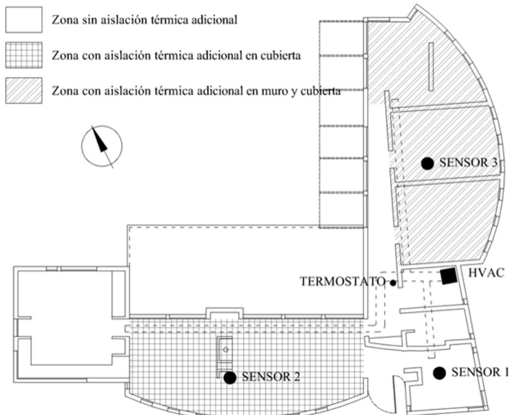
Figura 8: planta de la vivienda donde se sectorizan las diferentes tipos de envoltente, la ubicación de los dataloggers y el sistema de calefacción.
