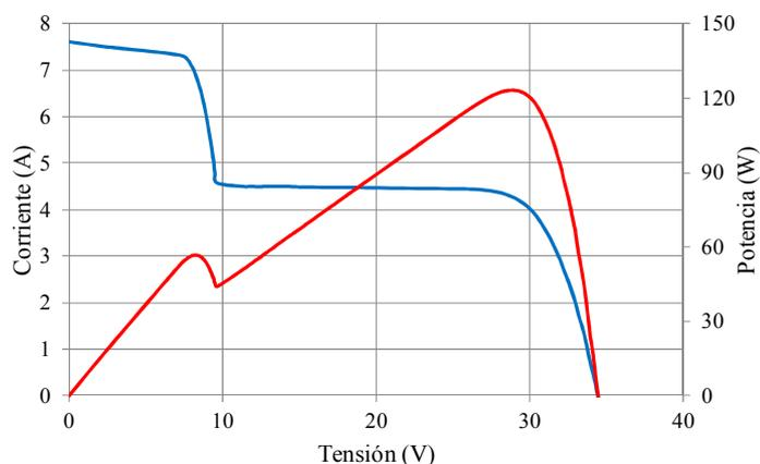
Figura 4: Corriente (en azul, eje izquierdo) y potencia (en rojo, eje derecho) en función de la tensión, obtenidas mediante simulación, generadas por un módulo FV de 240  $W_p$  con 2 submódulos (de 20 celdas solares en serie cada uno) parcialmente sombreados.
