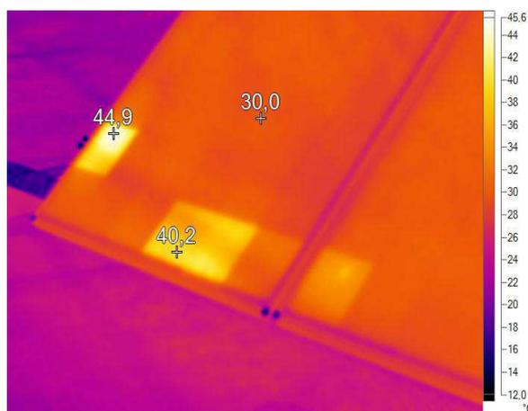
Figura 6: Termografía parcial de dos de los módulos del sistema compuesto por 12 módulos FV de 240 W<sub>p</sub> conectados en serie. Se aprecia la sombra con sus correspondientes puntos calientes.
