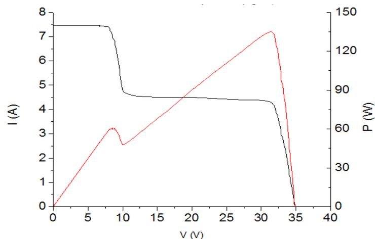
Figura 3: Corriente (en negro, eje izquierdo) y potencia (en rojo, eje derecho) en función de la tensión, generadas por un módulo FV de 240  $W_p$  con 2 submódulos (de 20 celdas solares en serie cada uno) parcialmente sombreados.
