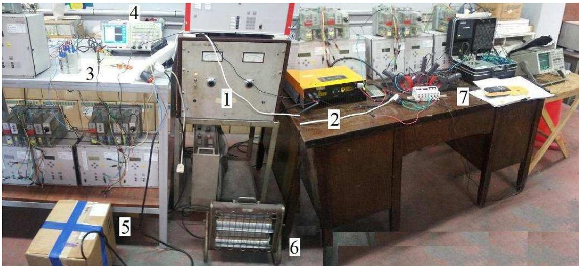
Figura 6: Vista de la configuración utilizada durante el ensayo: 1) fuente de alimentación DC, 2) inversor Sirio1500, 3) banco de capacitores, 4) osciloscopio, 5) reactancia, 6) carga resistiva, 7) pinzas amperométricas y llaves de corte.
