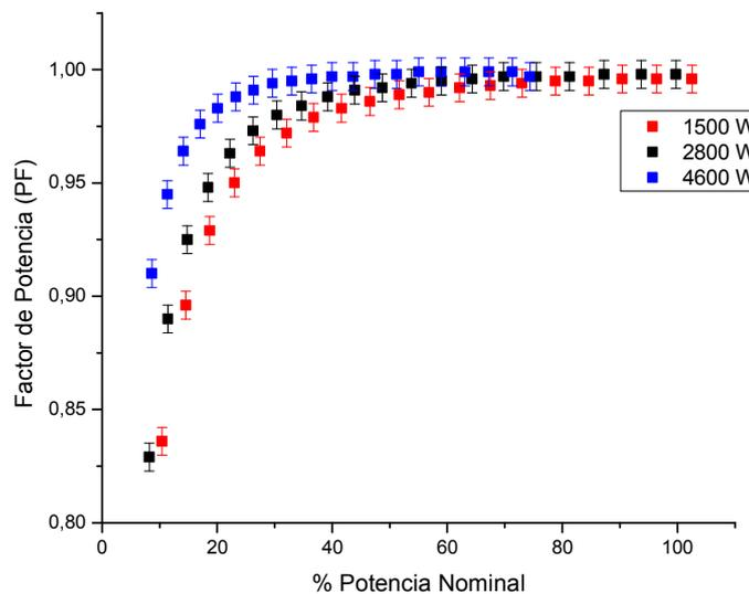
Figura 2: Curvas del factor de potencia en función de la potencia nominal (%) para los tres inversores ensayados.
