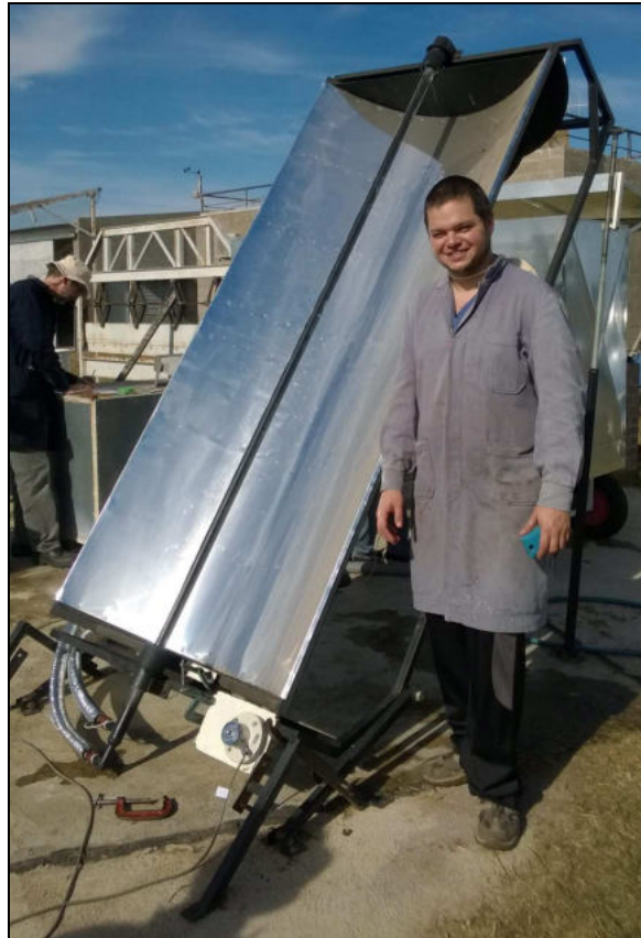
Figura 5: CCP instalado sobre la plataforma en posición invernal (junio)
