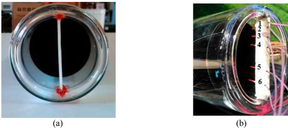
Figura 8: Distribuição dos sensores no tubo evacuado.
