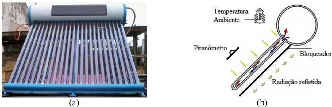
Figura 5: Coletor solar de tubos evacuados utilizado para os ensaios:
