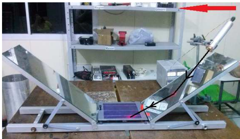
Figura 3 – Determinação experimental da função de aceitação angular.
