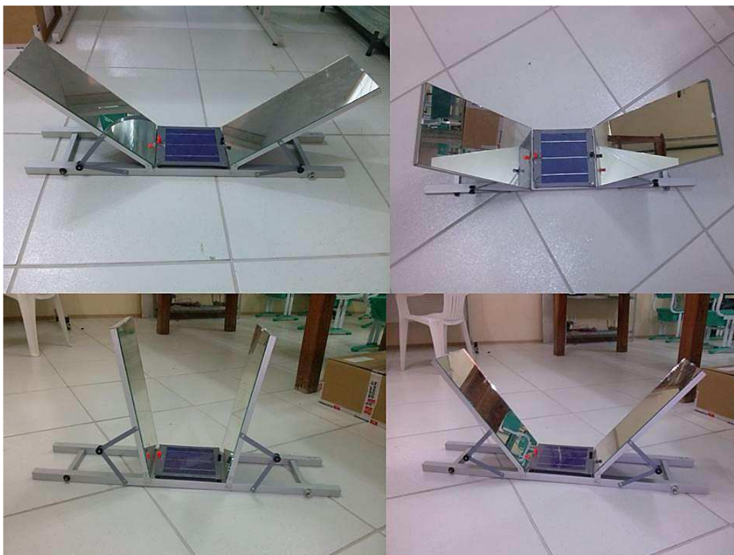
Figura 1: Concentrador solar tipo V desenvolvido.
