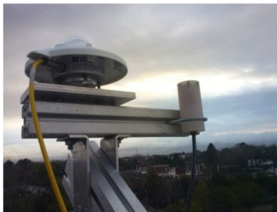
Figura 6. Imagen del Radiómetro acuático montado en aire para su contrastación con Solarímetro CMP6 de Kipp & Zonen.
