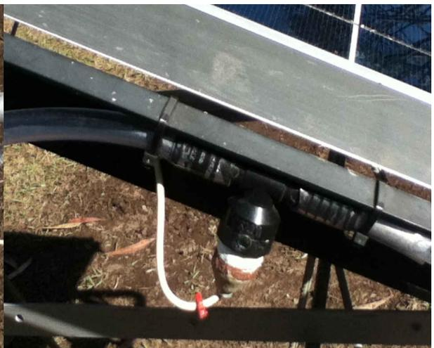
*Figura 5b: Detalle sensor de temperatura.*
