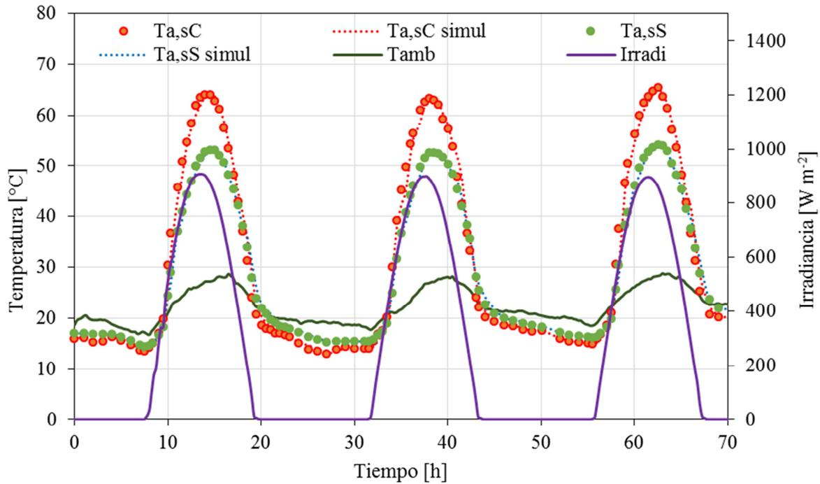
Figura 6. Ajuste de temperaturas experimentales y las obtenidas por la simulación numérica
