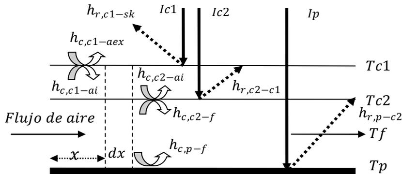
Figura 2. Esquema del balance en el colector
