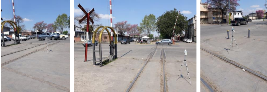
Figura 5: mediciones sonoras con instrumental.
