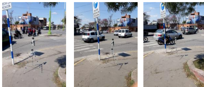
Figura 3: mediciones sonoras con instrumental en cruce de avenidas.
