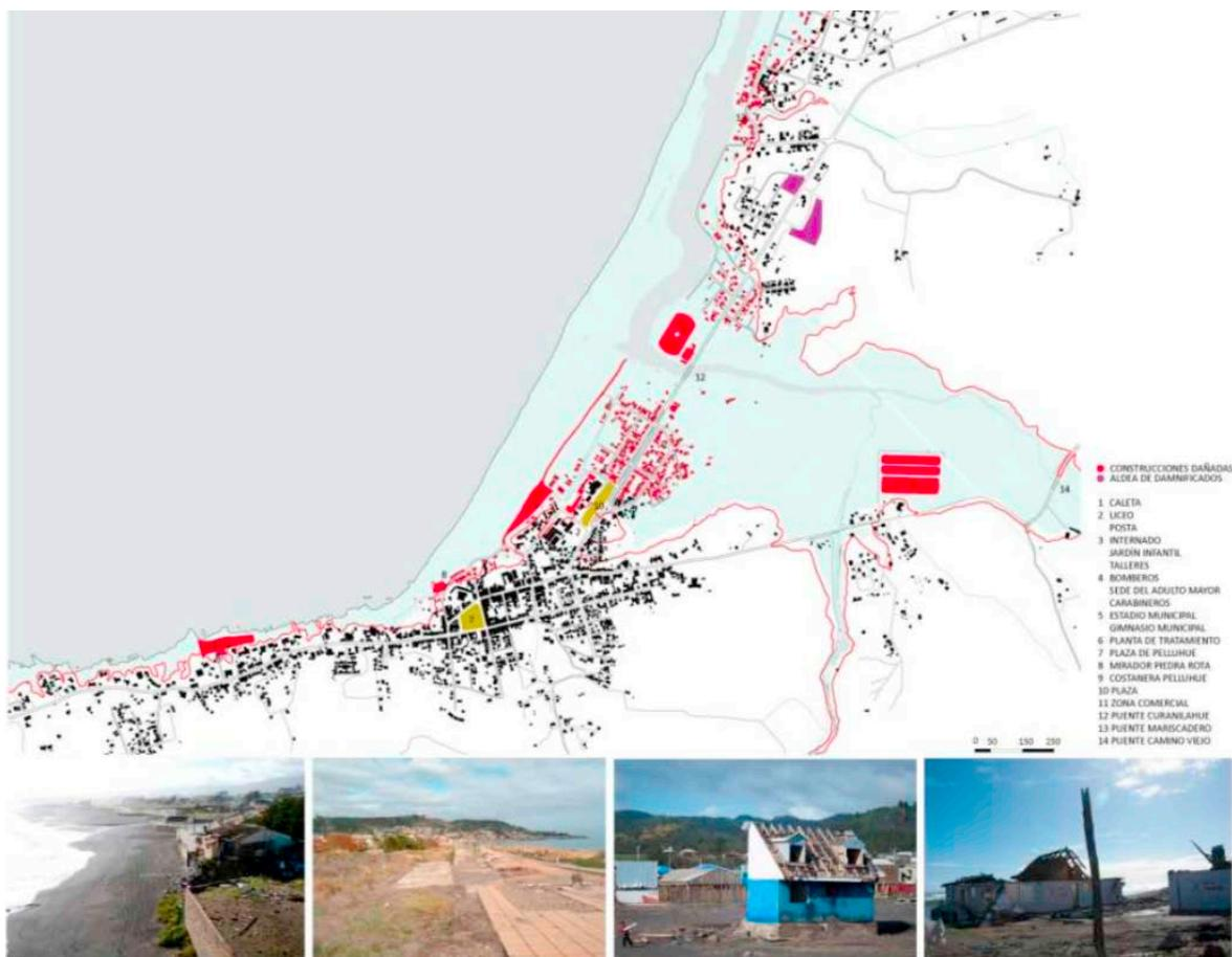
Fig. 87. Plano de inundación producida por el tsunami de Febrero de 2010 en Pelluhue. En línea roja se marca la cota máxima de inundación (run-up) en la cota 11 metros sobre el nivel del mar. Como se observa, gran parte del área afectada corresponde al borde costero y a las zonas adyacentes a la desembocadura del río Curanilahue. Fuente: PRES Pelluhue (2010).
