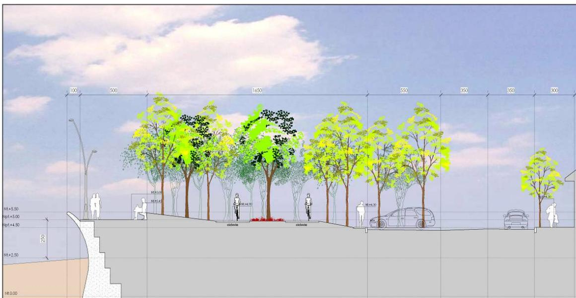
Fig. 101. Sección tipo del Parque de Mitigación del Borde Costero. En la imagen se observan los principales elementos que lo conforman: el muro rompeolas, cuya altura respecto al nivel del mar alcanza los 5,5 metros, aunque su altura efectiva desde el nivel medio de la playa no supera los 3 metros. A lo largo del Parque se dispone un buffer de arbolado de 20 metros de ancho. Fuente: Plan de Reconstrucción de Borde Costero, Plan Maestro de Dichato (2010).
